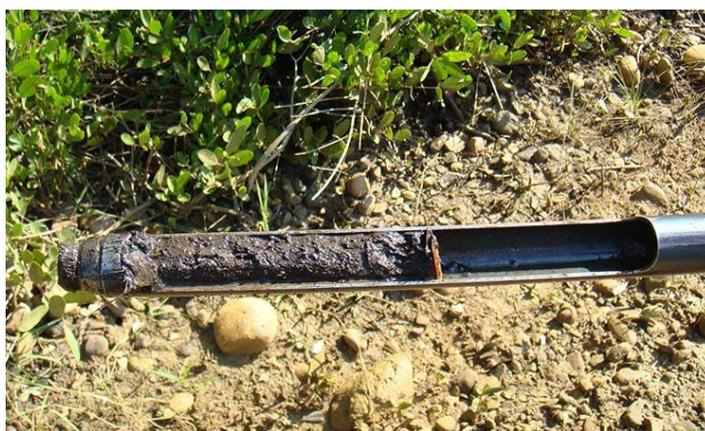
Fig. 29 Obtención de una muestra de suelo. Fuente: [www.agriculters.com](http://www.agriculters.com)
