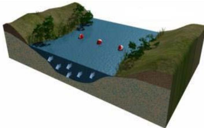
Fig. 27 Medición de corriente mediante boyas. Fuente: [www.tankonyvtar.hu](http://www.tankonyvtar.hu)
