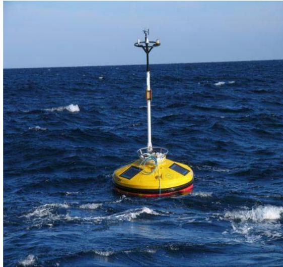
Fig. 26 Boya para medición de oleaje. Fuente: [www.elpais.com](http://www.elpais.com)
