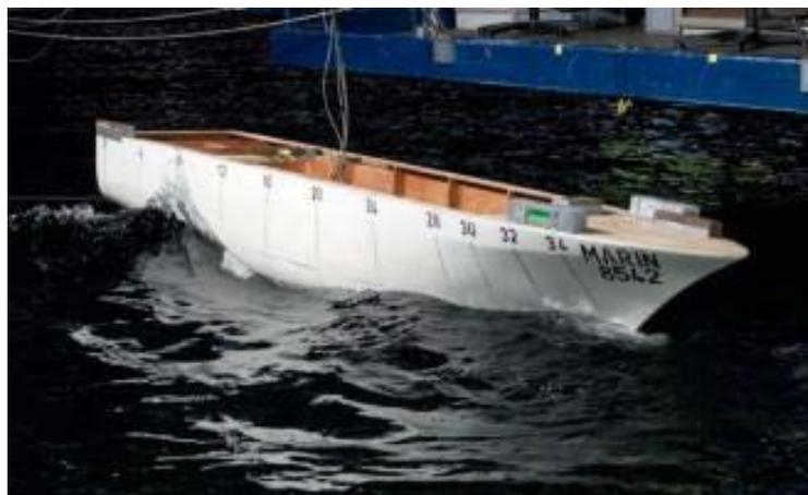
Fig. 39 Ensayo de seakeeping. Fuente: [www.oossanen.nl](http://www.oossanen.nl)
