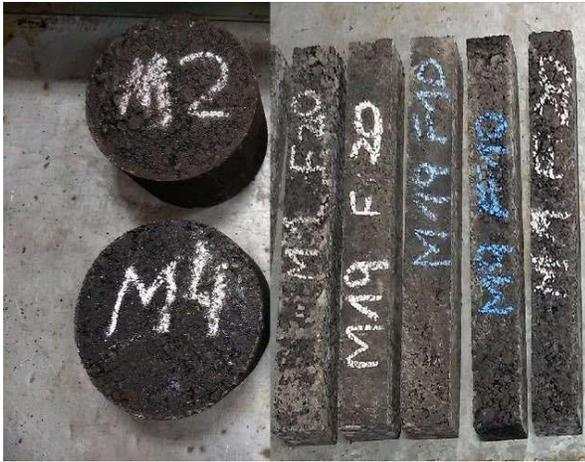
Figura 1. Probetas Tipo Marshall/Viga Prismática
