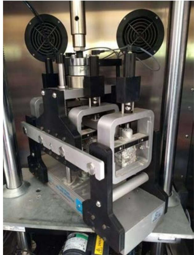
Figura 2. Máquina de Ensayo a Fatiga
