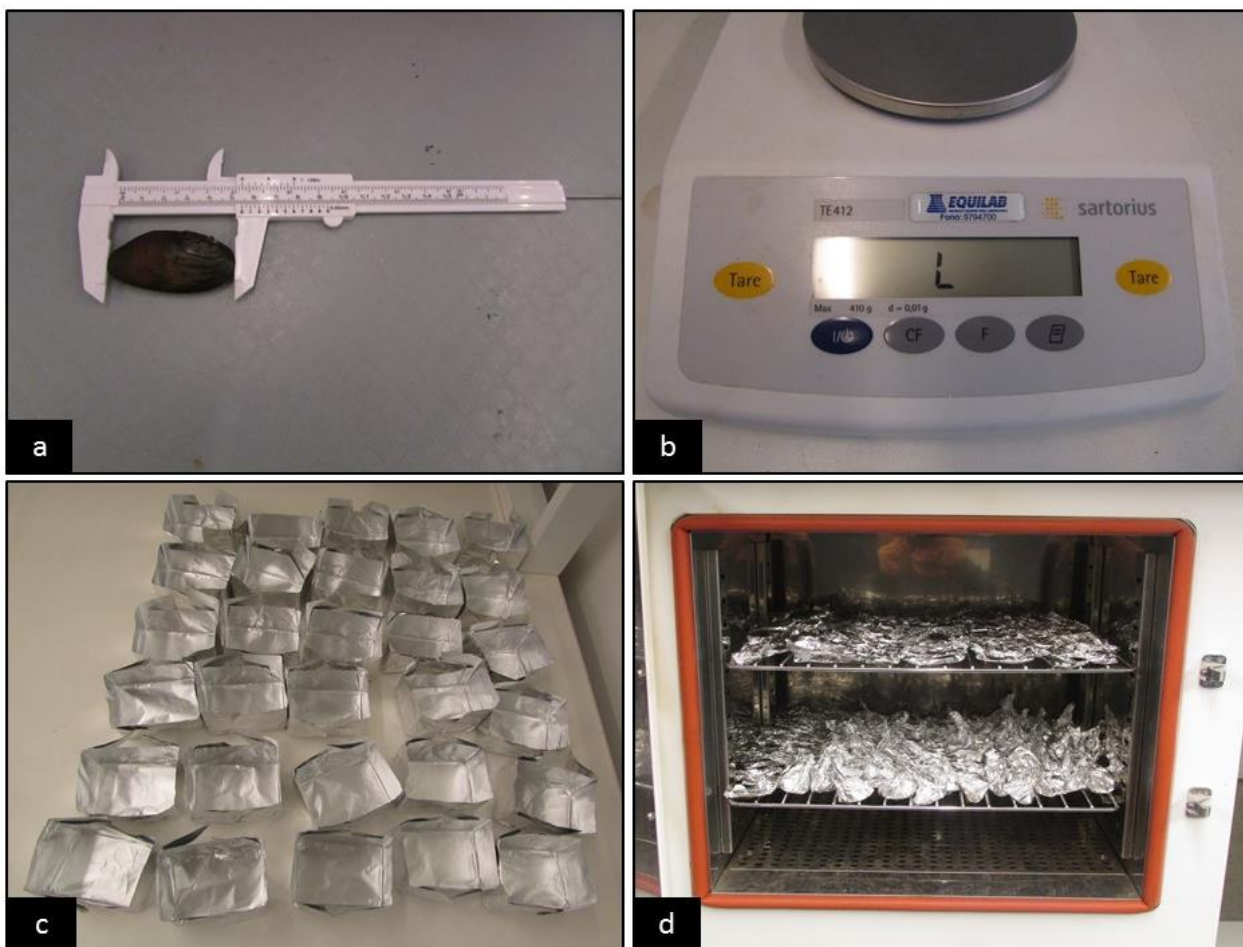
Figura 12 a: pie de metro. b: balanza digital SARTORIUS TE 412 ( d=0,01 g). c: cápsulas de aluminio, d: estufa de secado DAIHAN Lab Tech.
