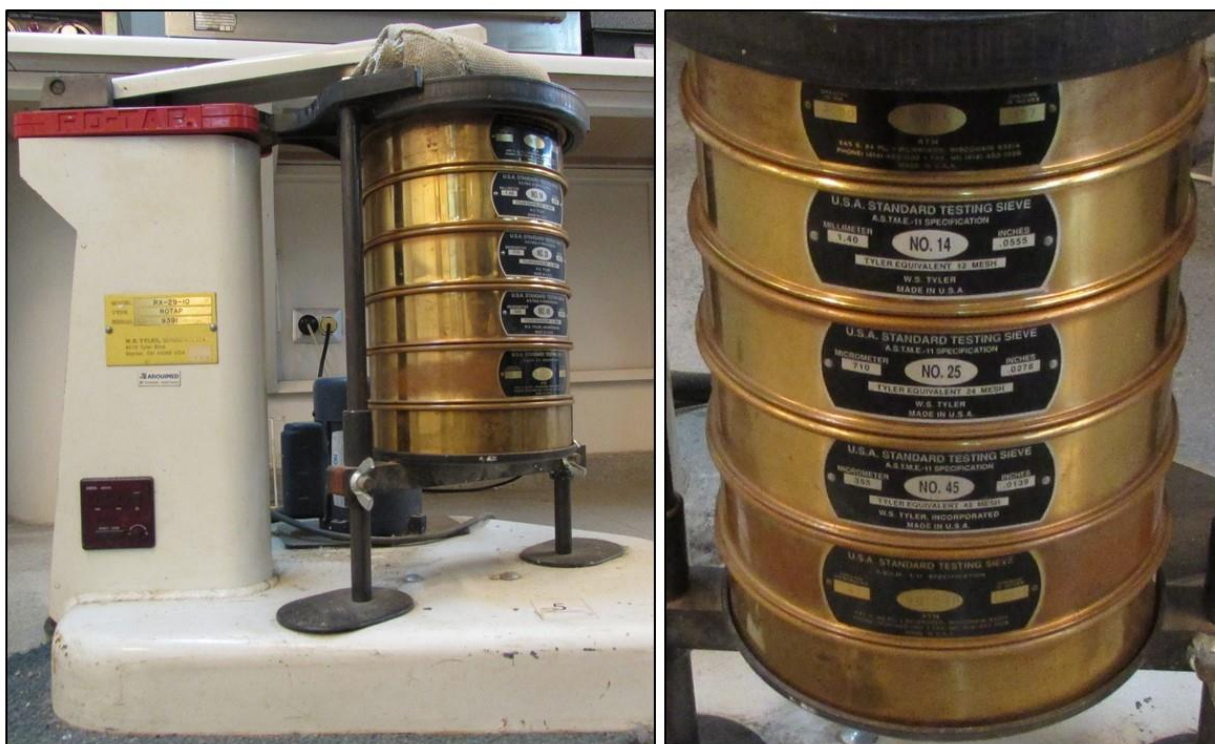
Figura 11. tamizador modelo RX-29-10 tipo ROTAP y cribas de 4 mm, 1,4 mm, 710 \mu\text{m} , 355 \mu\text{m} y 63 \mu\text{m} .
