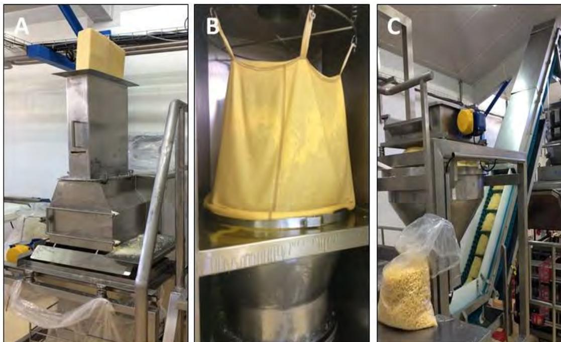
**Imagen 2.** Equipos utilizados en los ensayos del trabajo: A) ralladora Urshel, B) *batch* de deshidratación y C) envasadora Hayssen
