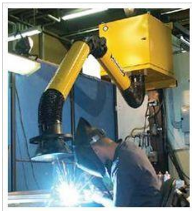
FIGURA 4.48: Ejemplo de extracción de humos de soldadura
