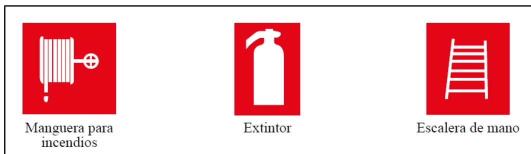
FIGURA 2.17: Ejemplos de señales relativas a equipos de lucha contra incendios.
