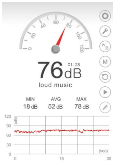
FIGURA 4.51: Medición de decibeles de la actividad corte de acero inoxidable con disco de corte.
