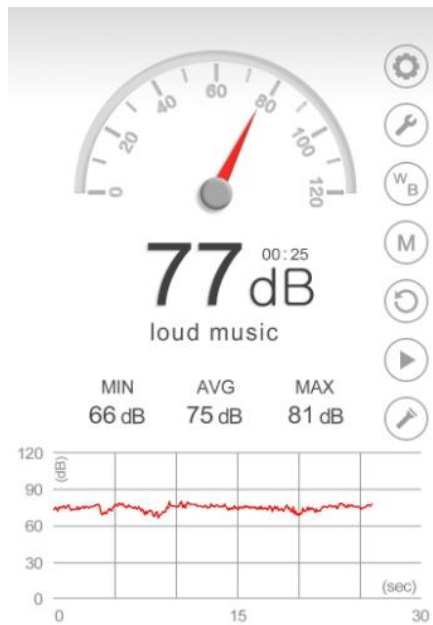
FIGURA 4.53: Medición de decibeles de la acción de pulir hierro
