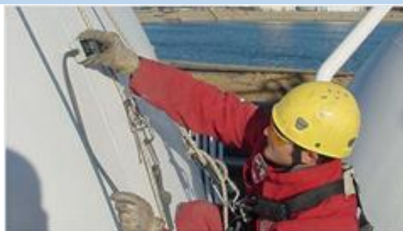
Fig. 4.34 Ensayo de medición de campo de corriente alterna (AkroScan. 2011).
