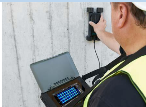
Fig. 4.26 Operario utilizando profómetro (Proceq. 2017 (I)).
