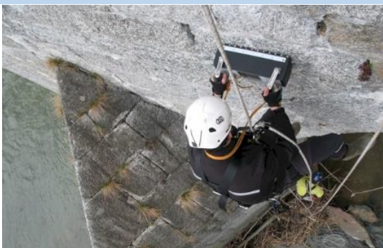
Fig. 4.16 Tomografía ultrasónica en análisis estructural (Foppoli. S.f.).
