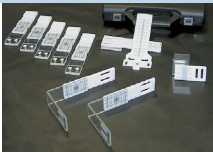
Fig. 4.7 Medidores de grietas (ControlsGroup. 2015).
