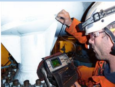
Fig. 4.33 Inspección por corriente de Foucault (Ropax. S.f).
