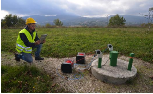
Fig. 4.17 Sistema Cross-Hole completo con 2 carretes motorizados. (ControlsGroup. 2015).
