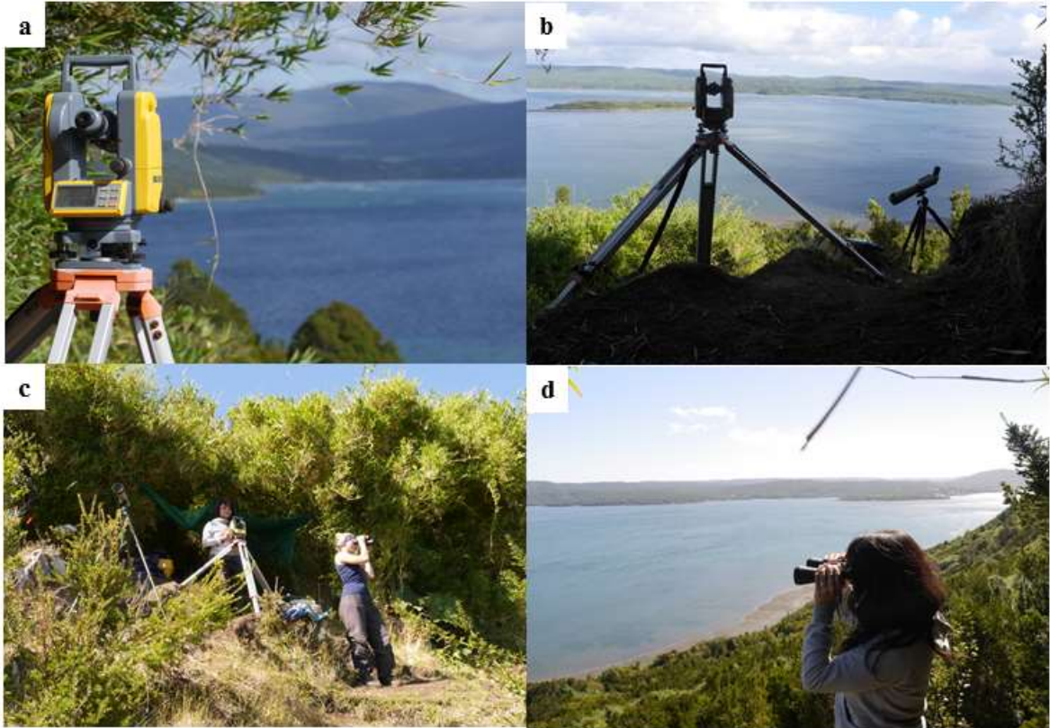
Figura 1. a, Muestra el instrumento topográfico Teodolito (Spectra Precision® DET-2).b, instrumento teodolito y telescopio terrestre. c y d observadores en terreno.
