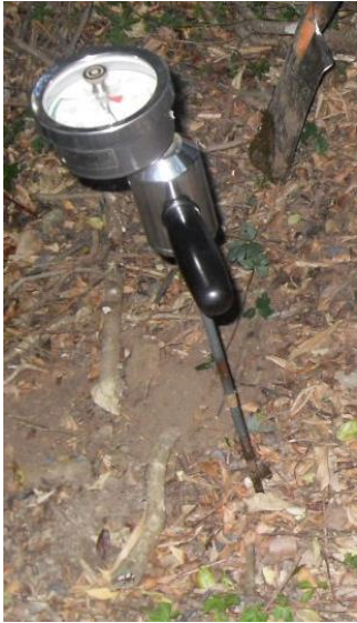
Imagen 6: Penetrómetro de campo utilizado en el estudio para determinar la resistencia a la penetración del suelo(N) en bosque nativo y pradera.
