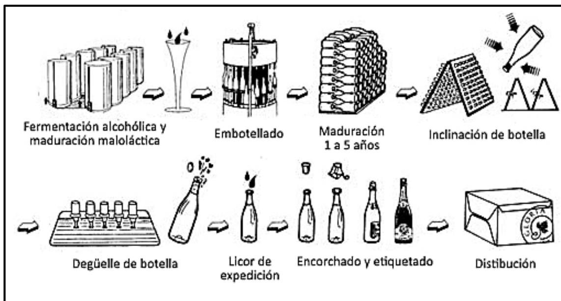
Figura 5. Esquema método Champenoise<sup>1</sup>
