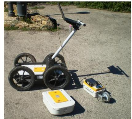
**Imagen 4.5** Sistema GPR RAMAC X3M con antenas de 250 MHz, 500 MHz y 800 MHz. [Fuente: Elaboración Propia].
