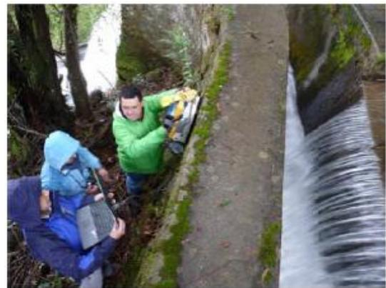
**Imagen 3.7** aplicación GPR en muro de Planta Hidroeléctrica Chivilingo [Fuente: Elaboración Propia].
