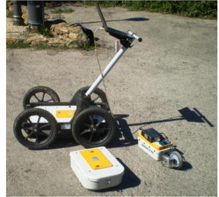
**Imagen 2.14** Sistema GPR RAMAC X3M con antenas de 250 MHz, 500 MHz y 800 MHz. [Fuente: Elaboración Propia].
