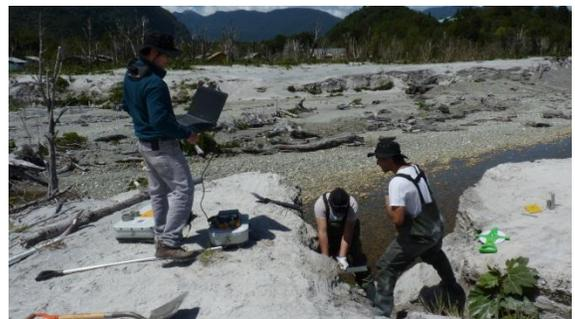
**Imagen 4.6** incrustando perfiles metálicos en ceniza húmeda. [Fuente: Elaboración propia]
