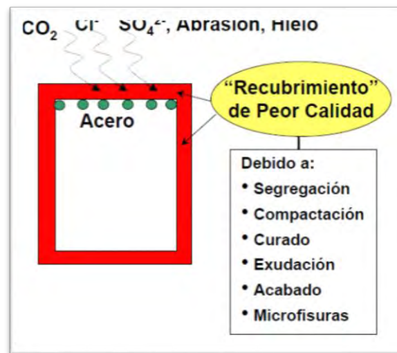
Figura 2.19. El recubrimiento como factor determinante de la corrosión. Fuente: Torrent, R. (2011).
