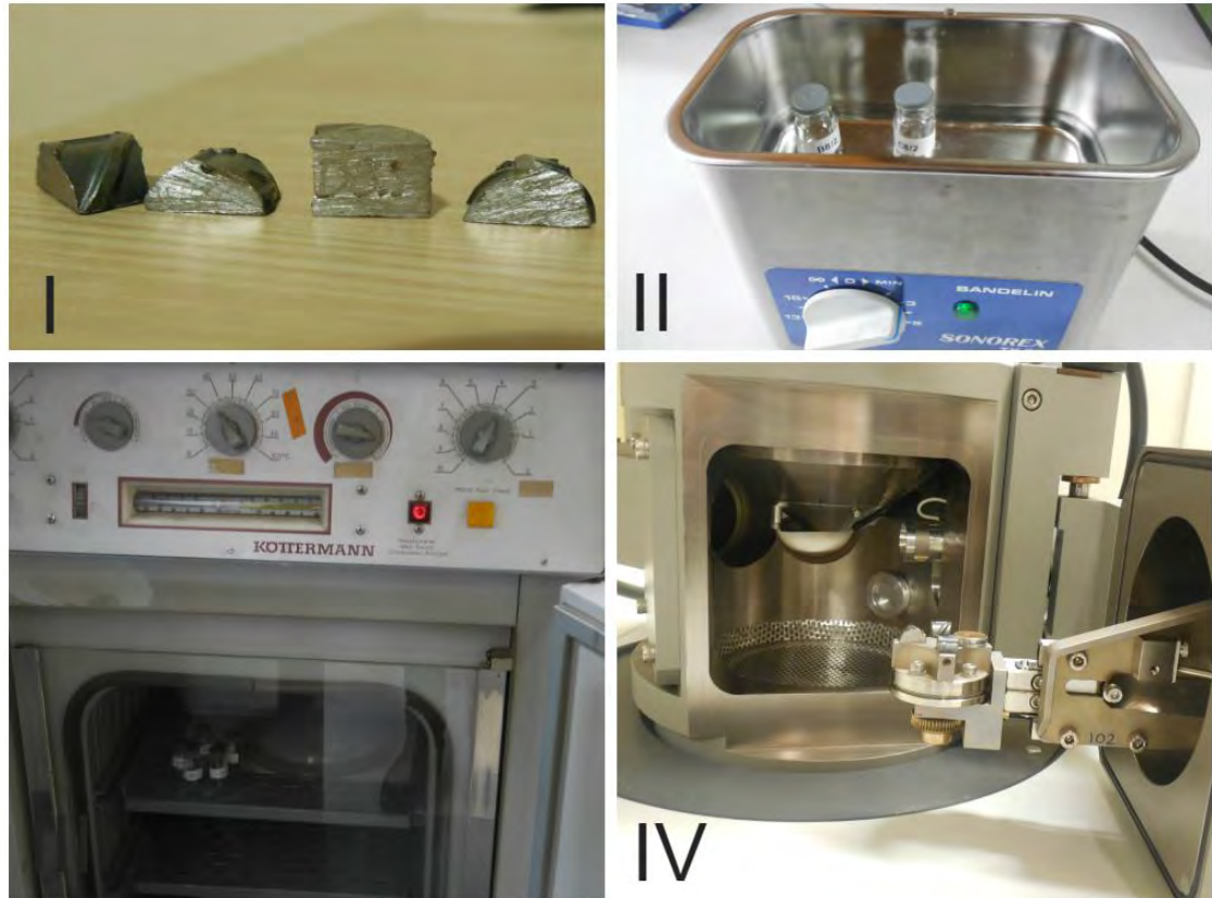
Figura 5.2. Preparación de muestras de acero para análisis por SEM y EDAX. Fuente: Elaboración propia
