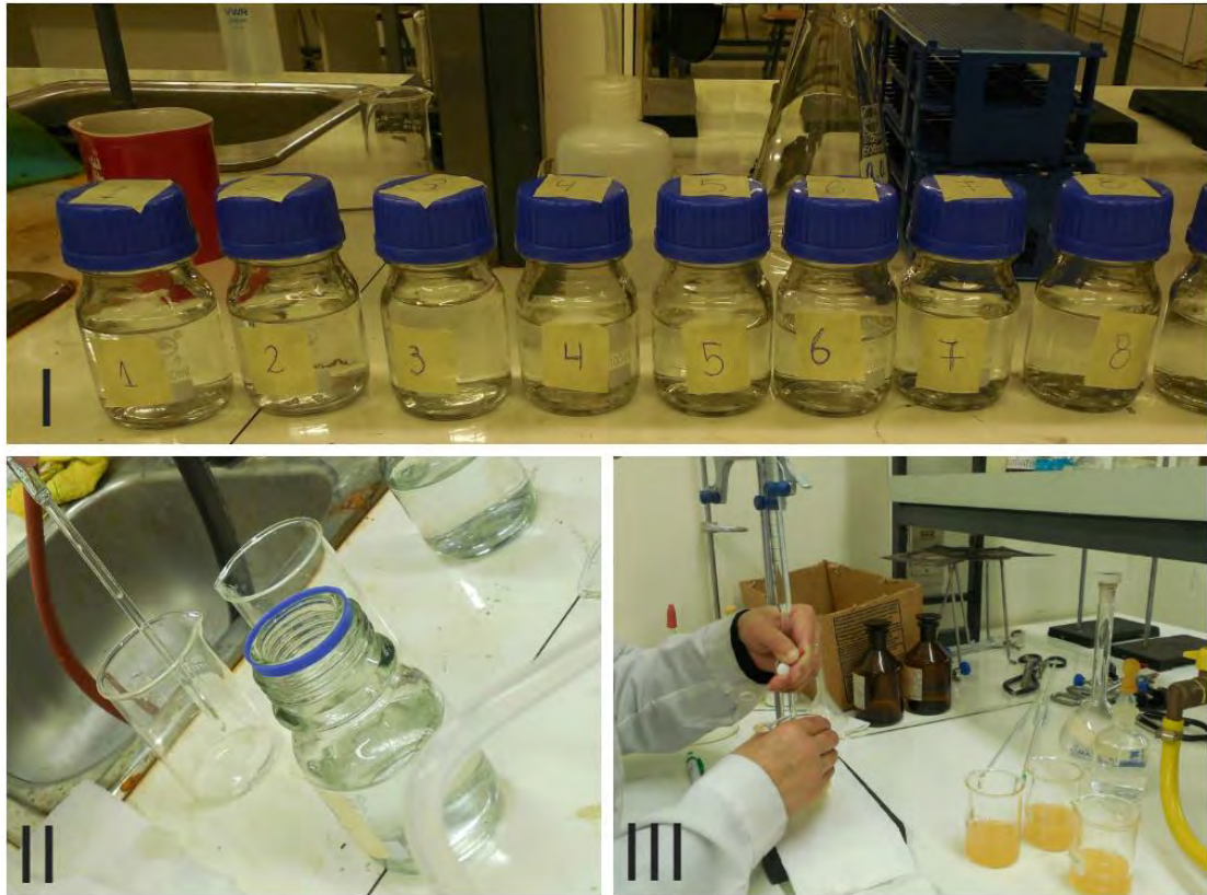
Figura 4.23. Obtención concentraciones de \text{Cl}^- mediante método de Mohr. Fuente: elaboración propia.
