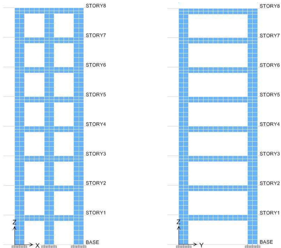
Figura 3.2.7.14: Mallado automático de elevaciones 1 y A.
