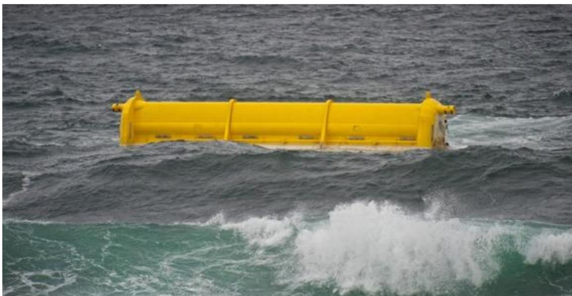
**Figura 23. Dispositivo Oyster en el mar. Disponible en: [www.aquamarinepower.com](http://www.aquamarinepower.com)**
