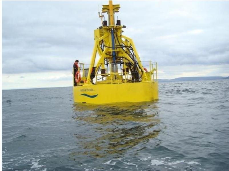
Figura 12. Dispositivos oceánicos Wave Bob, vista desde la superficie. Fuente: <http://sine.ni.com/>
