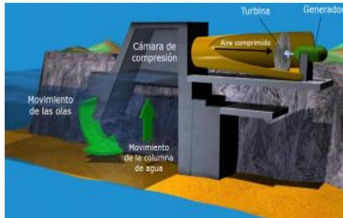
**Figura 3. Dispositivo de orilla “columna de agua oscilante”.**
