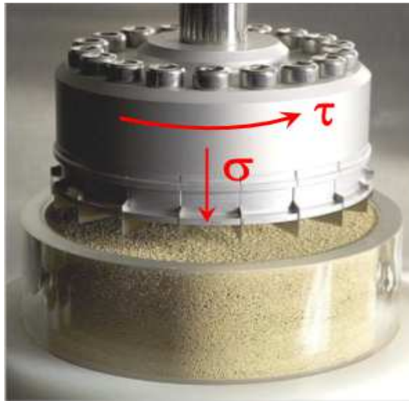
FIGURA 12. Esquema del pistón para test de cizallamiento FUENTE: Freeman Technology, 2008
