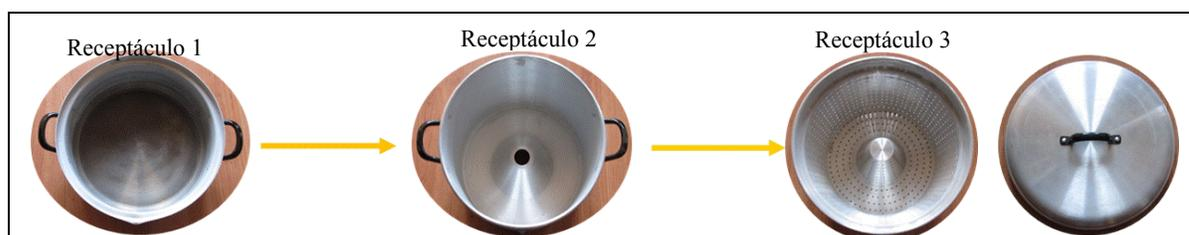
**FIGURA 4.** Olla extractora de jugo por arrastre de vapor.
