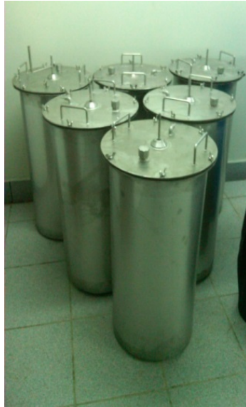
Figura N° 22: Digestores para el proceso anaerobio.
