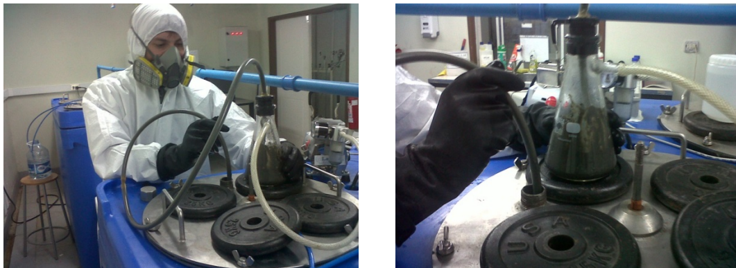
Figura N° 47: Extracción de lodo residual del digestor anaerobio.
