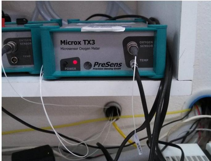
**Figura 2: Sensor óptico de Microx TX3 utilizado para medir la concentración de oxígeno.**
