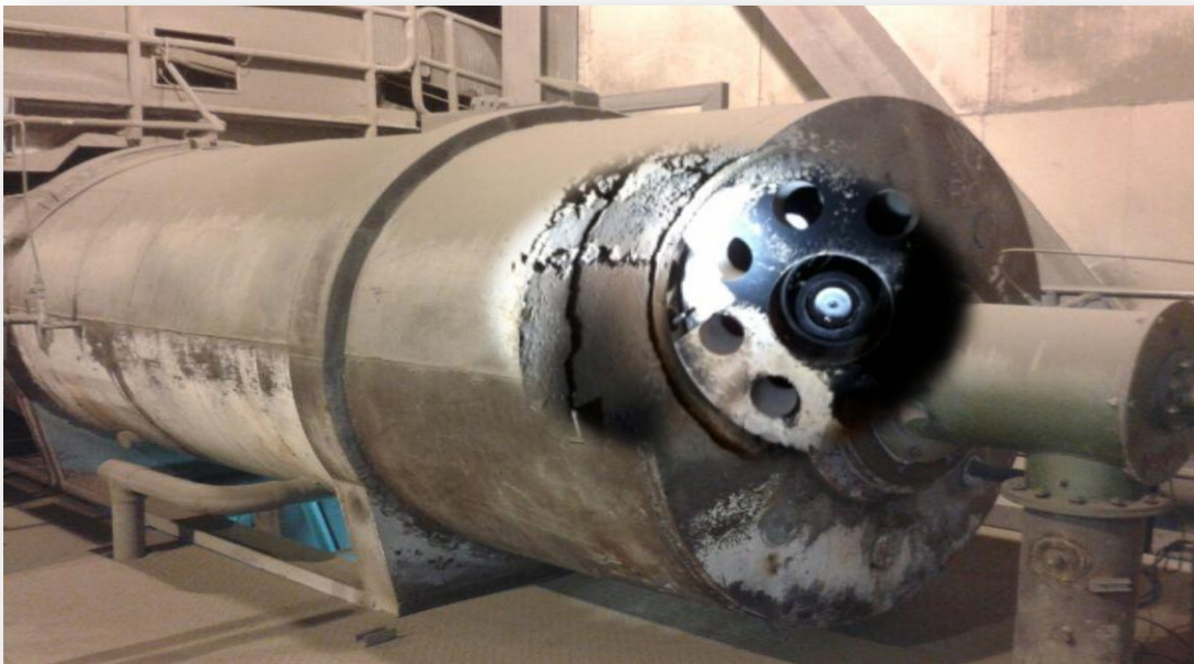
Figura N° 4.10: Generador de Calor Diésel. Depto. Producción. Planta Puerto Montt. Fuente: En base a información entregada por Cementos Melón S.A, 2013.
