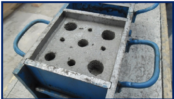
Figura 16: Recipiente con mortero de hormigón después de realizadas las mediciones (Elaboración propia).
