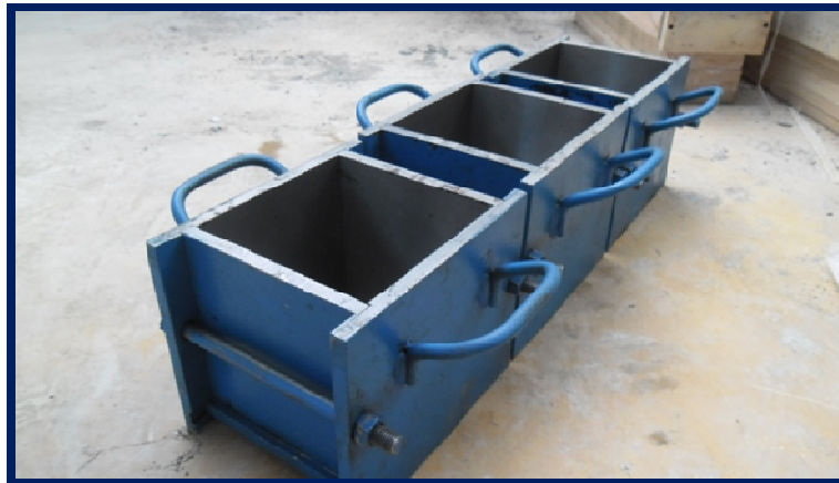
Figura 10: Recipientes utilizados para determinación del tiempo de fraguado (Elaboración propia).
