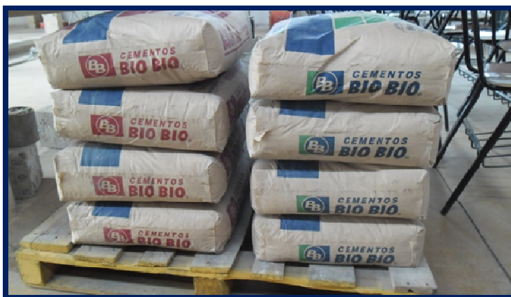
Figura 7: Cemento grado alta resistencia y corriente utilizados para elaborar las mezclas de hormigón (Elaboración propia).
