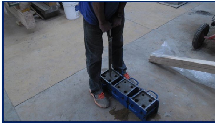
Figura 15: Medición de penetración para determinación del tiempo de fraguado (Elaboración propia).
