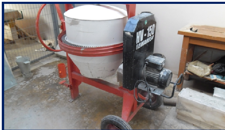
Figura 11: Mezclador mecánico utilizado para elaborar los hormigones (Elaboración propia).
