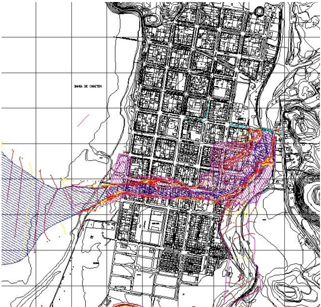
Figura 15. Plano Topográfico del río Blanco después del embancamiento (1:2000)
