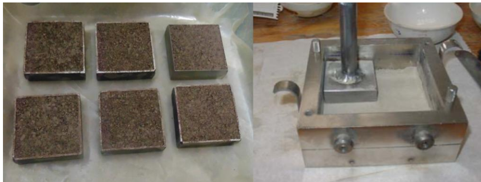
Fig. 5.08 - Confección de moldes para ensayo de corte directo
