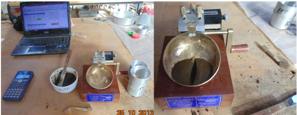
Fig. 5.03 - Ensayo de límite líquido
