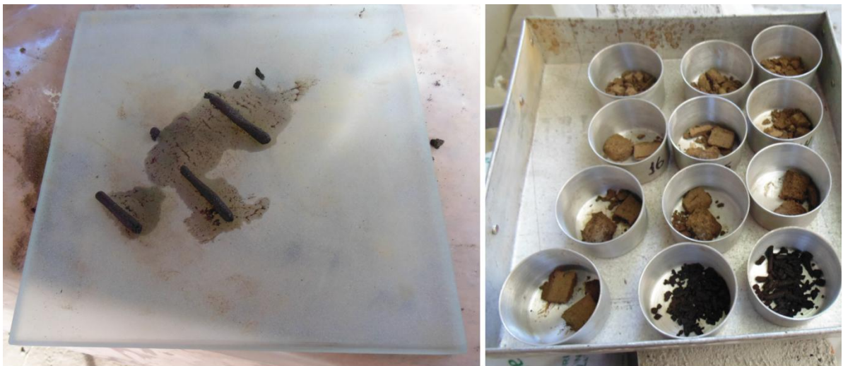
Fig. 5.04 - Ensayo de límite plástico
