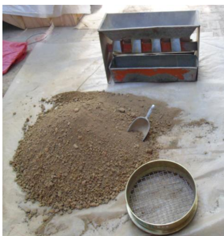
Fig. 5.02 - Proceso de Cuarteo para ensayo de granulometría
