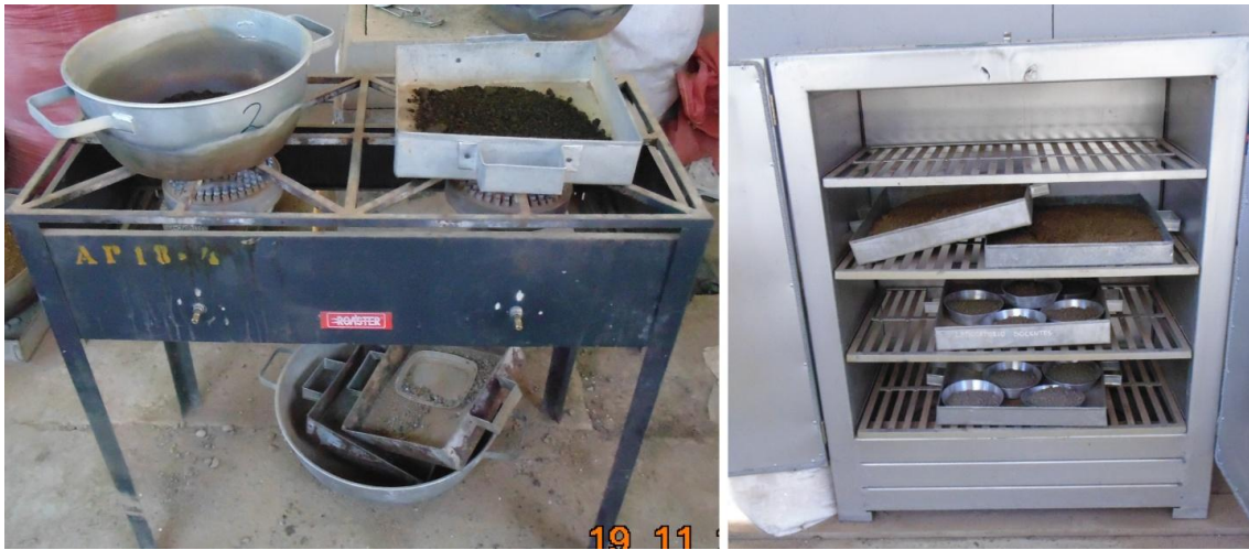
Fig. 5.06 - Proceso de secado del material en cocina y horno respectivamente (Fuente: Elab. Propia)
