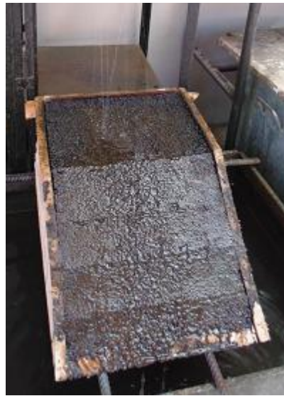
Fig. 6.8 – Erosión en modelo a escala del suelo con 6% emul. asfáltica
