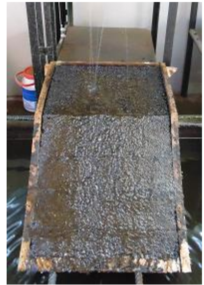
Fig. 6.8 – Erosión en modelo a escala del suelo con 6% emul. asfáltica
