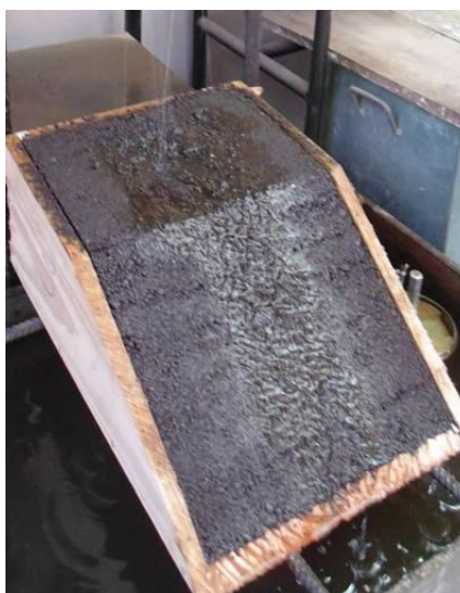
Fig. 6.6 – Erosión en modelo a escala del suelo con 2% emul. asfáltica
