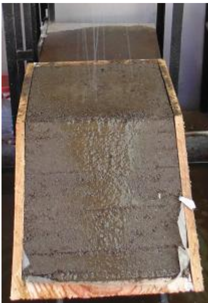
Fig. 6.5 – Erosión en modelo a escala del suelo con 2% cemento
