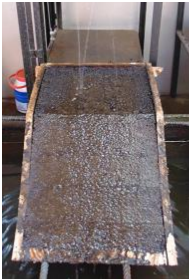
Fig. 6.8 – Erosión en modelo a escala del suelo con 6% emul. asfáltica
