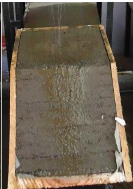
Fig. 6.5 – Erosión en modelo a escala del suelo con 2% cemento
