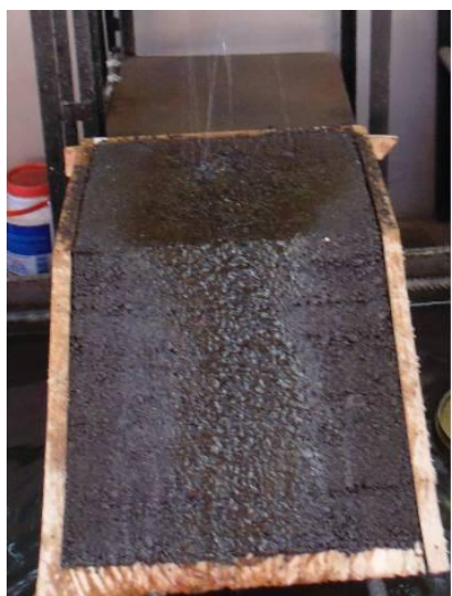
Fig. 6.6 – Erosión en modelo a escala del suelo con 2% emul. asfáltica
