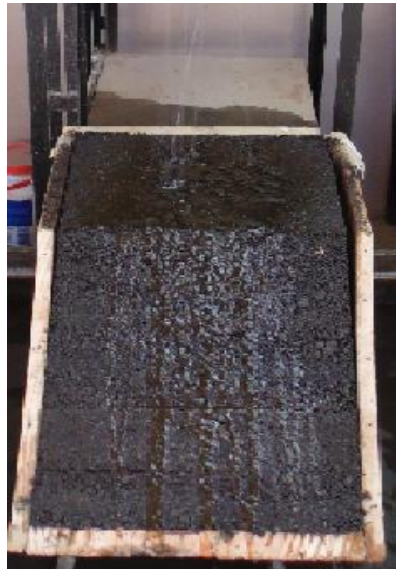
Fig. 6.7 – Erosión en modelo a escala del suelo con 4% emul. asfáltica
