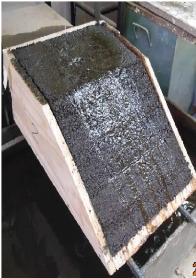
Fig. 6.7 – Erosión en modelo a escala del suelo con 4% emul. asfáltica
