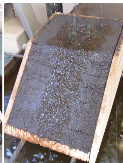
Fig. 6.6 – Erosión en modelo a escala del suelo con 2% emul. asfáltica
