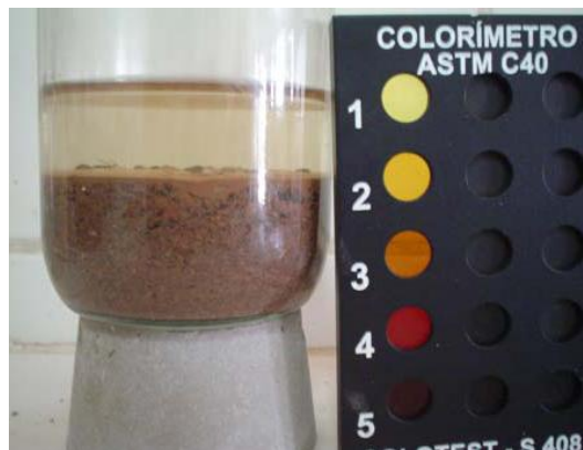
Fig. 5.05 - Ensayo contenido de material orgánico
