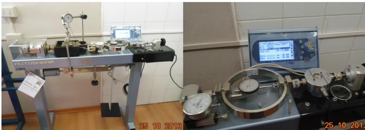
Fig. 5.07 - Ensayo de corte directo
