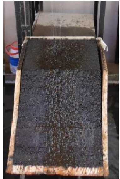
Fig. 6.7 – Erosión en modelo a escala del suelo con 4% emul. asfáltica
