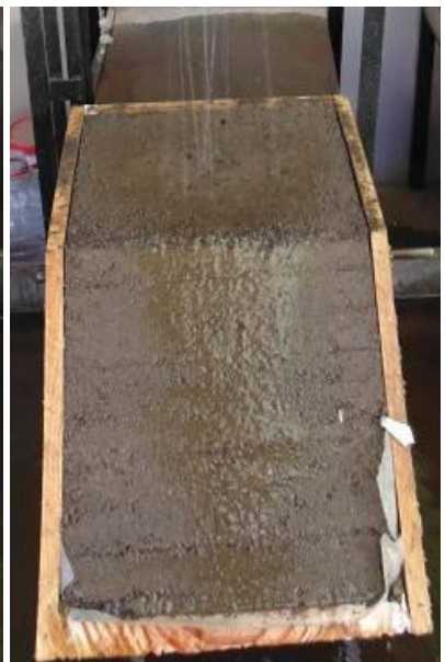
Fig. 6.5 – Erosión en modelo a escala del suelo con 2% cemento
