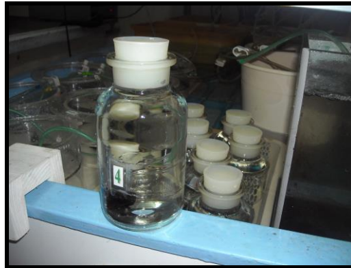
Figura 6: Cámaras de incubación utilizadas para medir el consumo de oxígeno y tasa de excreción de C. chorus .
