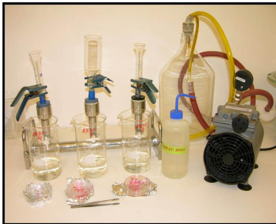
Figura 5: Set de filtración, utilizado para fijar las heces de C. chorus , para eficiencia de absorción.
