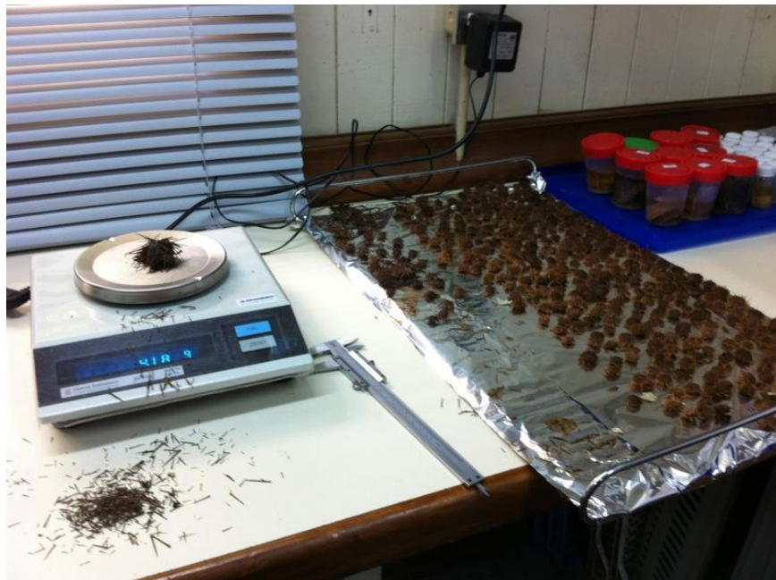
Figura 4: Bandeja para secar los erizos y balanza digital, utilizados para el análisis de diámetro – peso seco.
