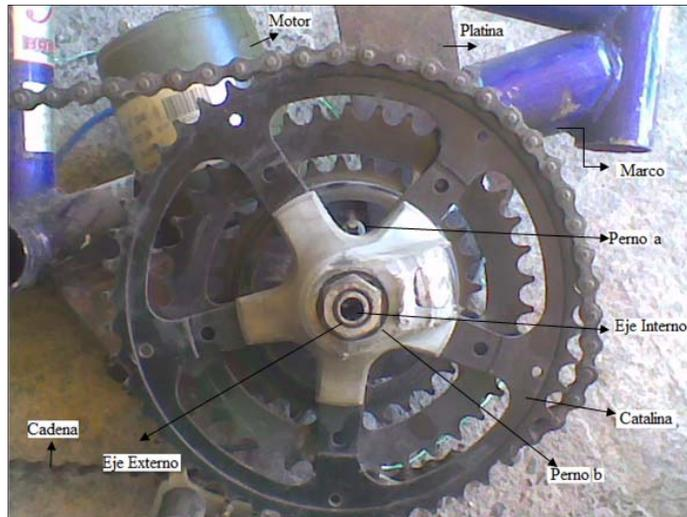
**Figura N° 30:** Eje externo para catalina.
