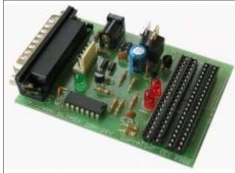
**Figura N° 37:** Programador PIC-PG3B.
