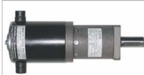
*Figura N° 29: Motor-reductor usado.*
