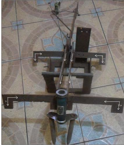
**Figura N° 15:** Ranuras para hacerlas adaptables a modelos de sillas.
