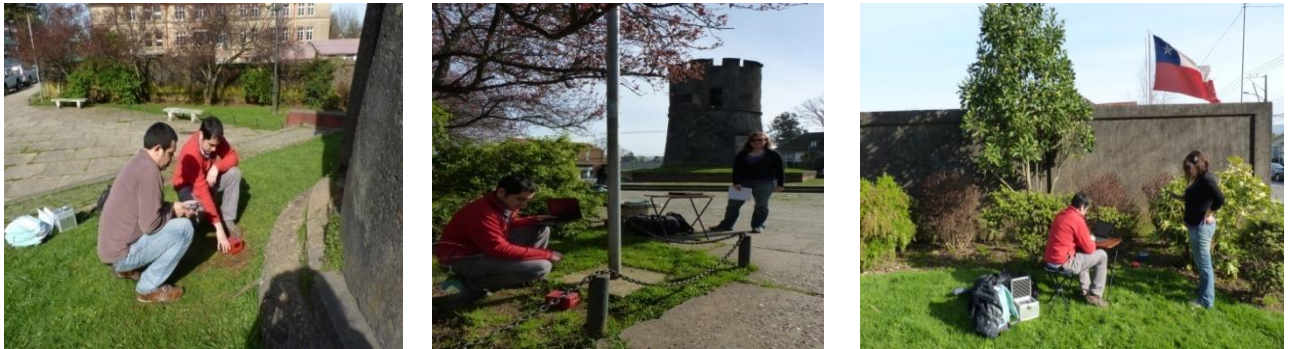
Fig. 5.4: Campaña de mediciones en terreno. De izquierda a derecha: 1) Medición con el sismómetro en el suelo, al pie del torreón. 2) Medición con el sismómetro y el geófono en un punto cercano al torreón, lado Yerbas Buenas. 3) Medición con el sismómetro y el geófono en un punto cercano al torreón, lado Gral. Lagos.
