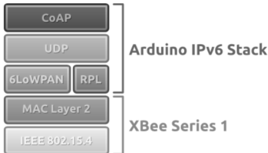
Figura 4. Arduino-IPv6Stack de Telecom Bretagne
