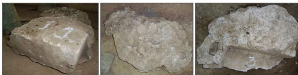
Figura 5. 2: Muestras de hormigón del Puente Pedro de Valdivia.
