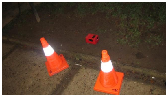
Figura 5. 13: Campaña de medición de frecuencias fundamentales de suelo.
