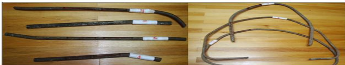
Figura 5.6: Siete armaduras de acero liso del Puente Pedro de Valdivia a ensayar.
