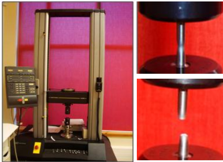
Figura 5. 7: A la Izquierda: Máquina universal Instrons. A la derecha: ensayo de tracción. Fuente: Elaboración propia.
