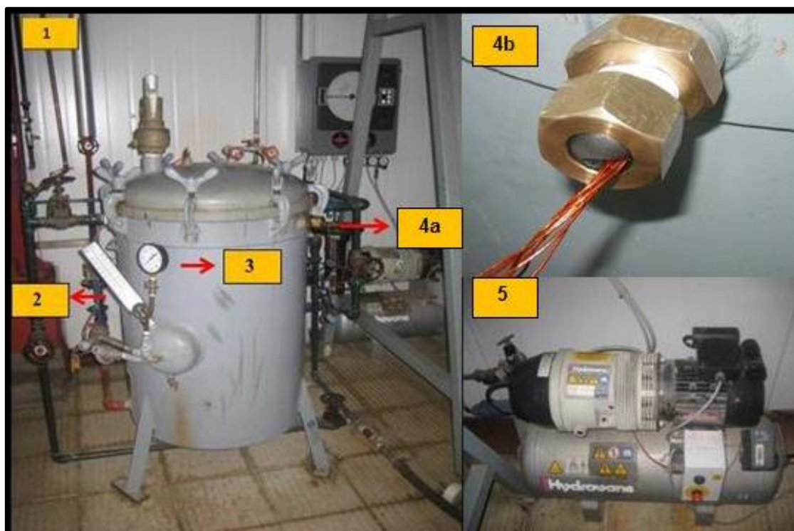
FIGURA 17 Sistema de esterilización. Autoclave vertical DIXIE (1). Termómetro TRERICE (2). Manómetro USG (3). Adaptador de Bronce (4a y 4b). Compresor Hydrovane (5).
