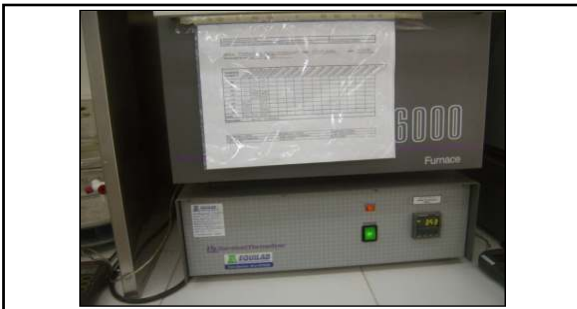
FIGURA 2 Mufla marca THERMOLYNE modelo TYPE 6000 FURNACE.
