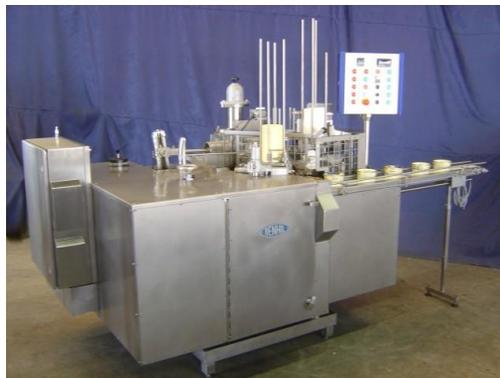
Figura 2.5: Máquina BENHIL 8205 Llenadora y Selladora, para formato de mantequilla de 200 gr.
