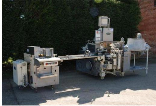
Figura 2.6: Máquina BENHIL 8380 Llenadora y Selladora, para formato de mantequilla de 125 gr.
