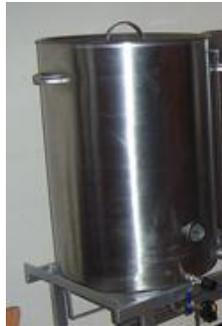
Figura N° 3.4: Olla maceradora con capacidad de 150 litros.
