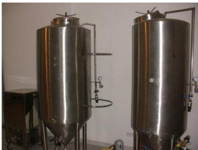
Figura N° 3.10: Tanques de fermentación Acero Inoxidable.
