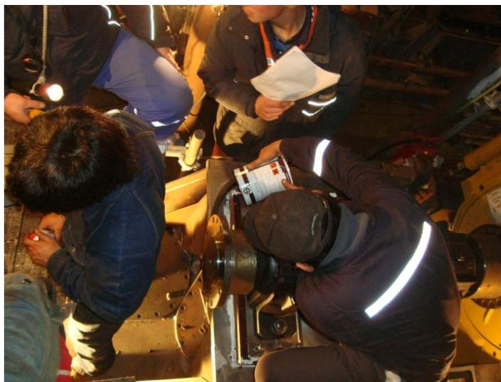
Figura 14: Aplicación EPOCAST (Resina Epóxica) sobre descansos del eje propulsor.
