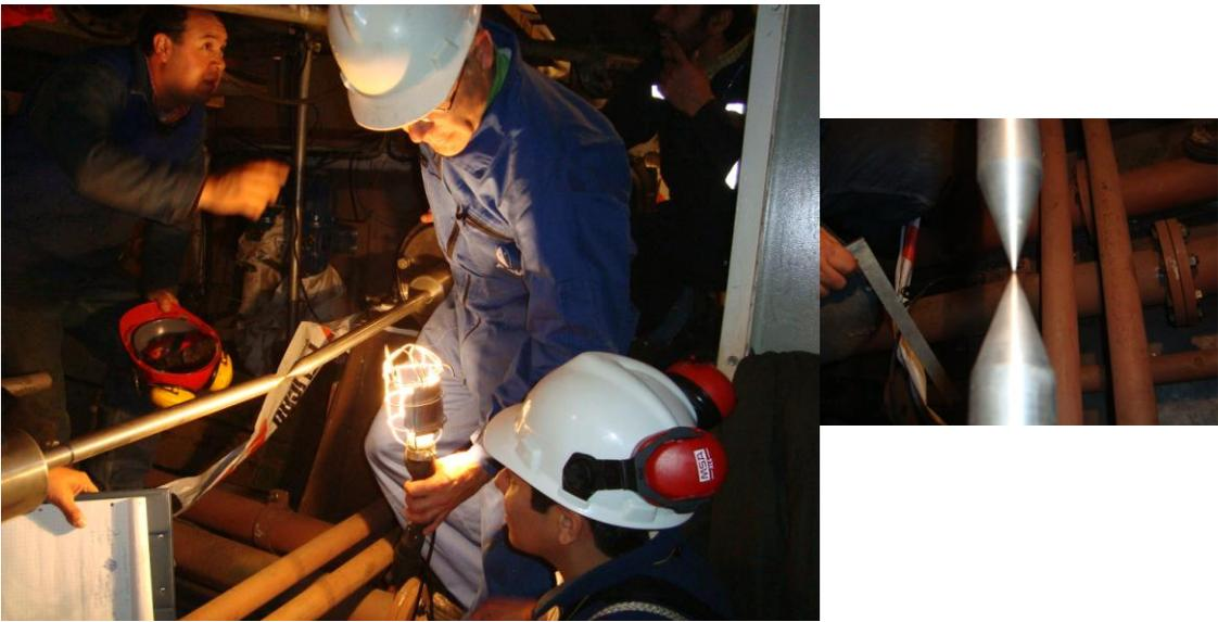
Figura 12: Inspector Lloyd's Register realizando medidas del eje y tolerancia de las uniones por medio de un cardan.
