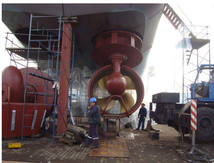
Figura 6: Equipo propulsor alineado, maniobra de izada.
