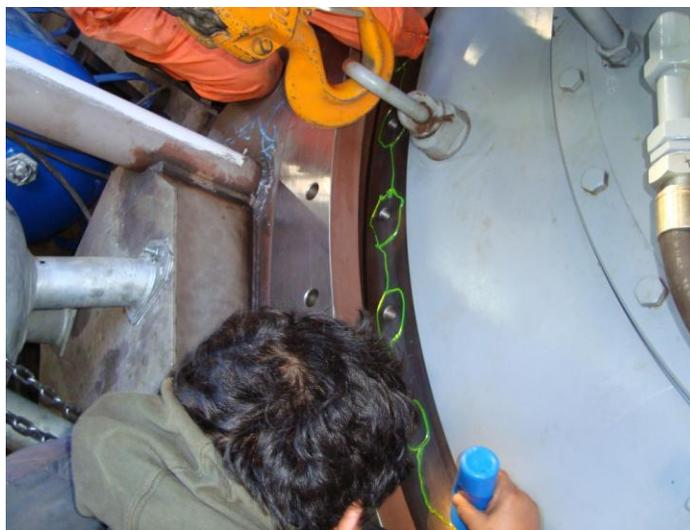
Figura 7: Aplicación sello y reten del equipo propulsor.
