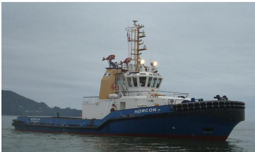
Figura 1: Remolcador de Bahía, 65 ton bollard pull
