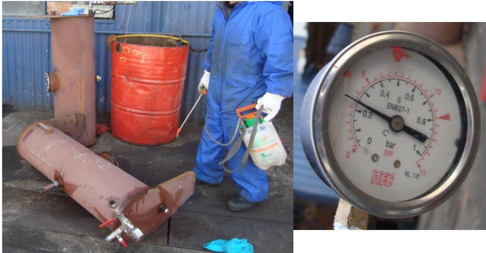
Figura 4: Prueba neumática (aplicación solución jabonosa a cordones de soldadura), estanque expansión motor principal
