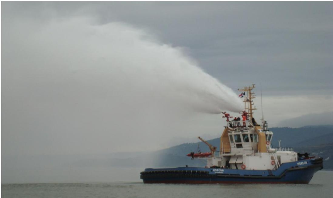
Figura 25: Prueba de mar, prueba del sistema contraincendios (Fi-Fi)
