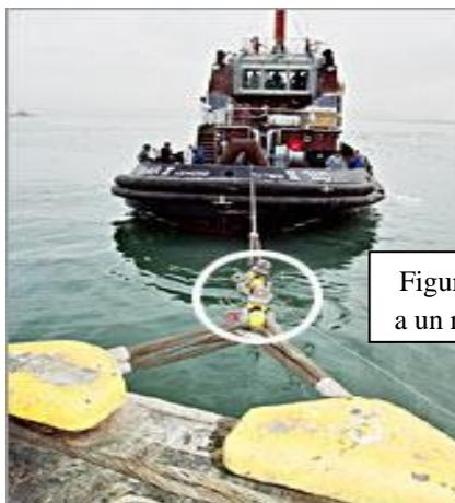
Figura 20: Prueba de tiro a un remolcador de bahía.
