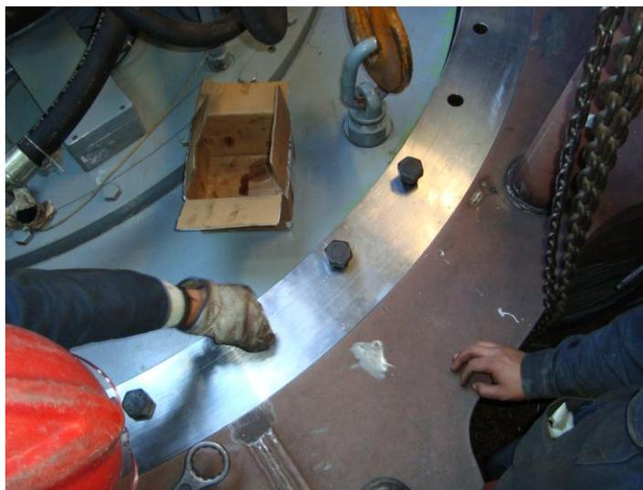
Figura 8: Pernos de fijación del equipo propulsor.
