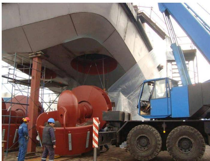
Figura 5: Maniobra de montaje equipo propulsor lado estribor
