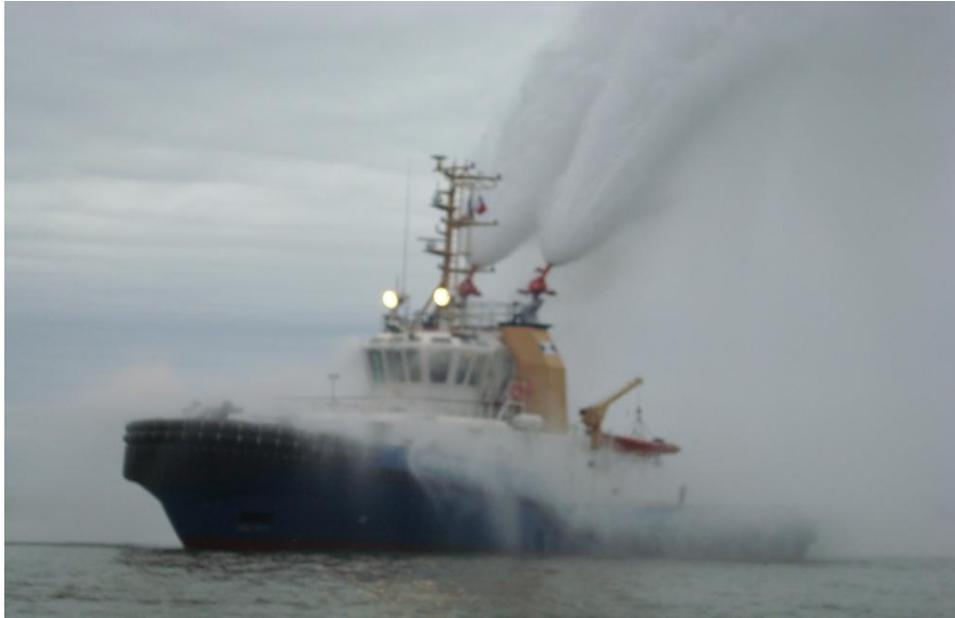
Figura 26: Prueba de mar, prueba del sistema contra-incendio (Water-Spray)
