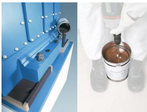
Figura 13: Proceso de EPOCAST (Resina Epóxica) y catalizador, aplicación EPOCAST (Resina Epóxica) sobre descansos.
