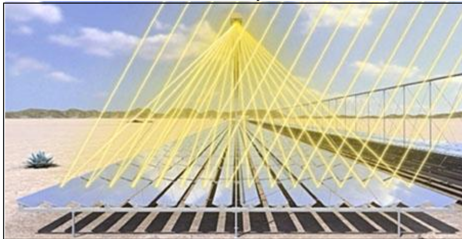
4.37: Planta solar Tipo Fresnel
