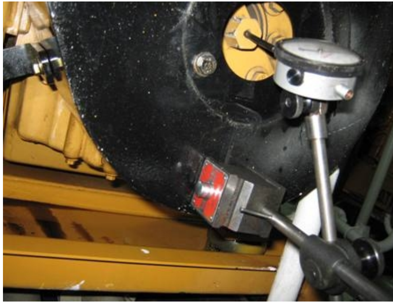
Figura 2.17. Holgura de Cigüeñal Fuente: Finning Chile
