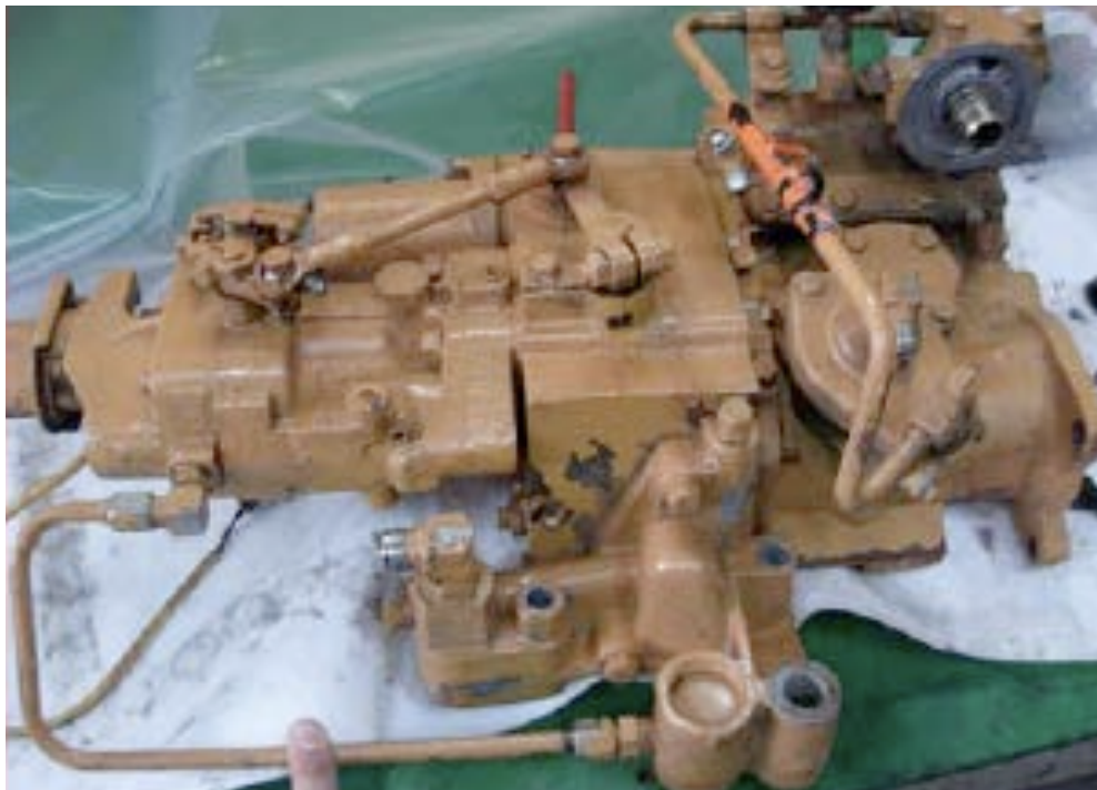
Figura 2.11. Sistema de combustible
