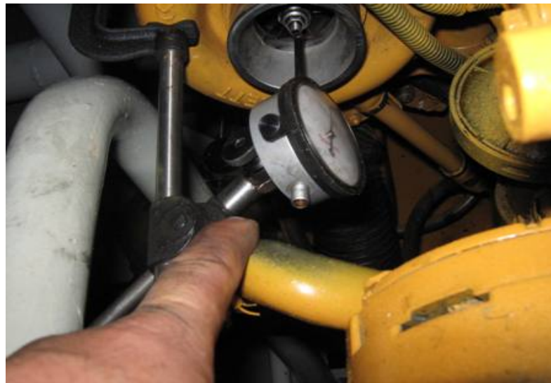
Figura 2.18. Holgura del Turbo Fuente: Finning Chile
