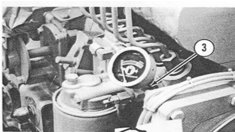
Figura 2.13. Punto de medición de presión de combustible
