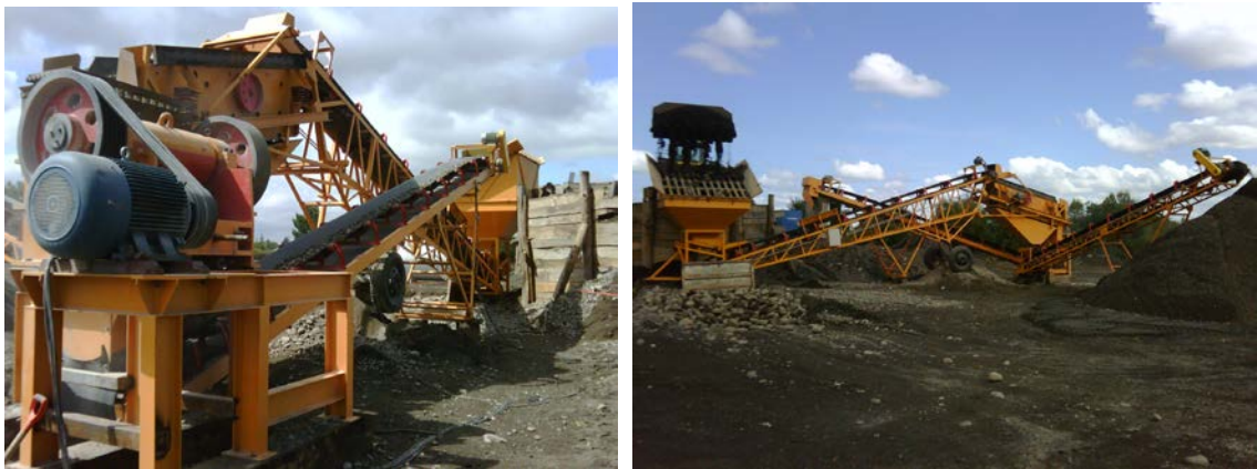
LAYOUT PLANTA SELECCIONADORA PS - 90 PARA CHANCADO DE ARIDOS 30 - 45 m 3 /h
