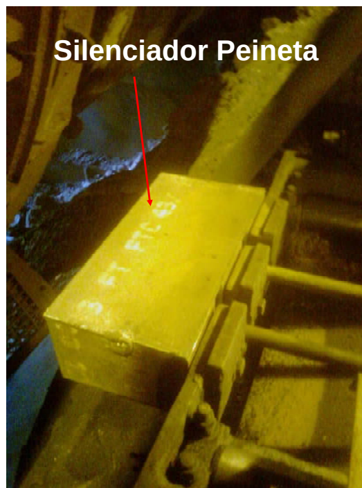
Figura 8.3. “Silenciador Peineta Sujeta a Maquina Gaspé”
