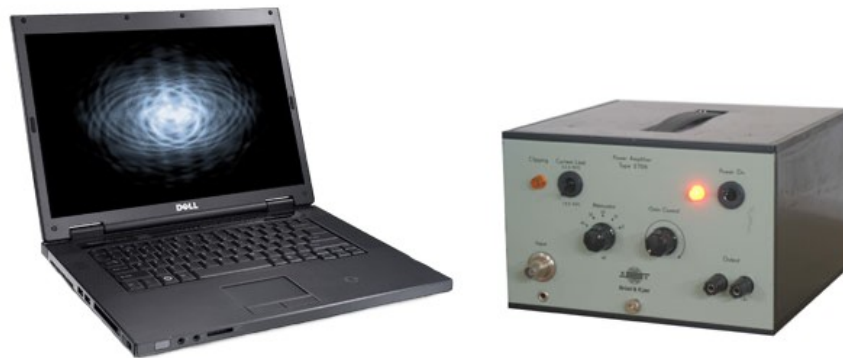
Figura 4.7. Computador portátil generador de ruido Blanco con Software MATLAB y Amplificador de potencia Bruel & Kjaer.
