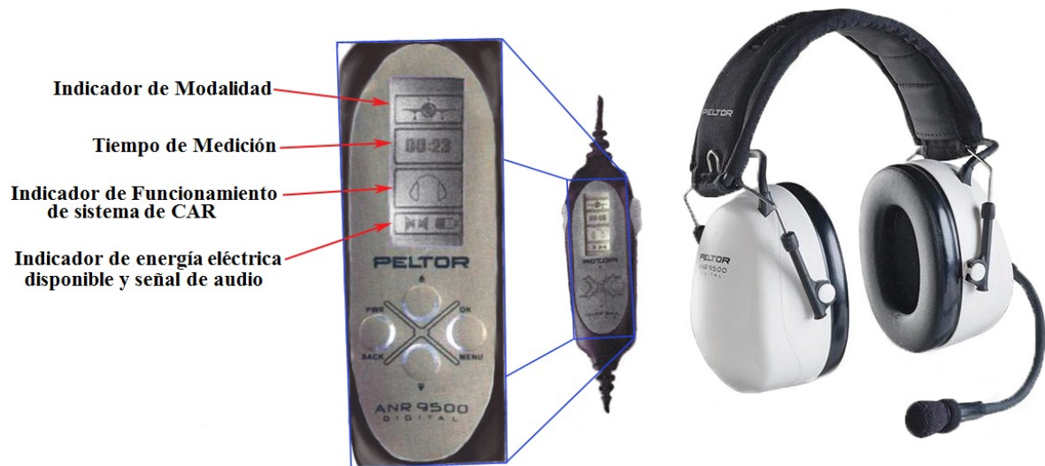
Figura 4.4. Auricular con micrófono PELTOR ANR 9500, con su unidad de control externa indicando las opciones del menú.
