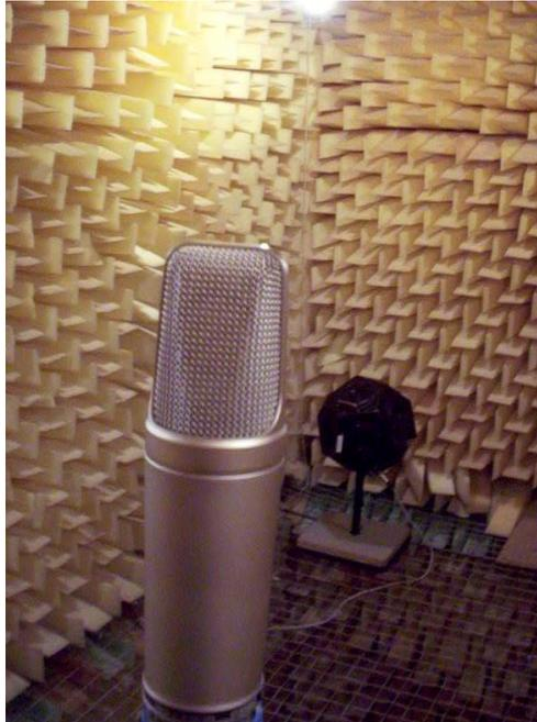
*Figura 6.29:* Medición en cámara anecoica.
