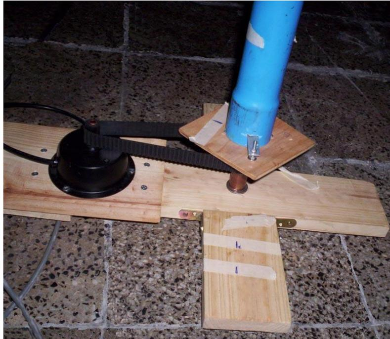
*Figura 6.26: Base giratoria de 0,75 rpm.*
