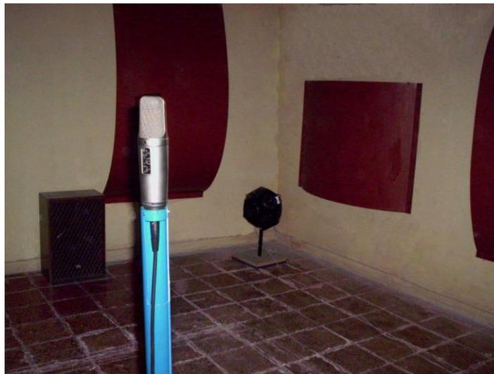
*Figura 6.30:* Medición en cámara reverberante.
