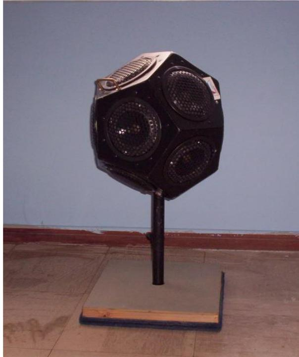
*Figura 6.24: Fuente omnidireccional.*
