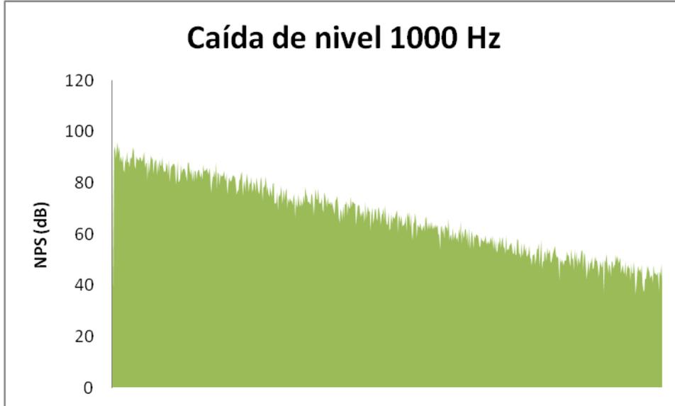
*Figura 6.7:* Caída de nivel de banda de tercio de octava de 1000 Hz.
