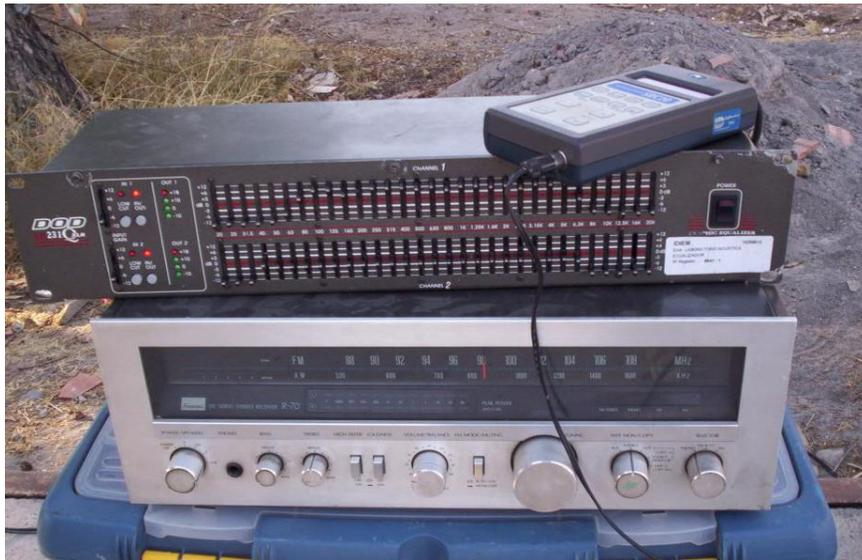
Figura 6.15: Equipamiento; generador de ruido, ecualizador y amplificador.
