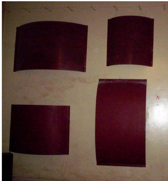
*Figura 6.9:* Elementos difusores de la cámara reverberante.
