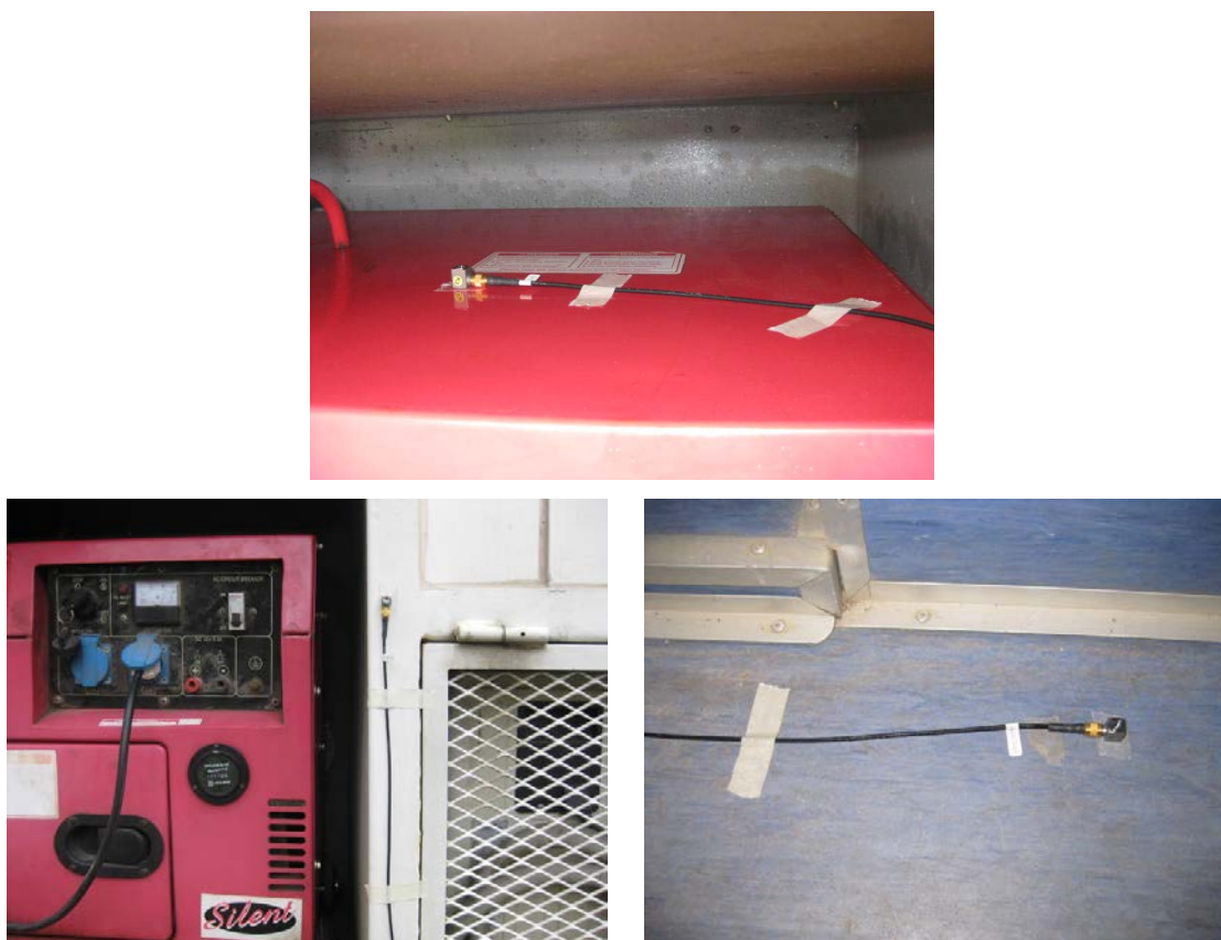
Figura 5.19: Ubicación de acelerómetro triaxial al momento de obtener los registros de aceleraciones correspondiente al funcionamiento del generador eléctrico.
