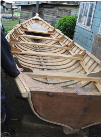
Fotografía 5: Bote en construcción, Pucatrihue
