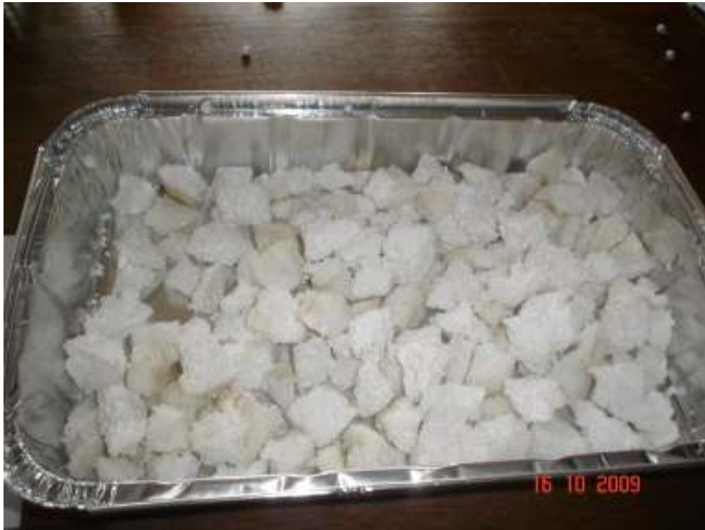
Figura 4: Material granular de poliestireno expandido modificado. (Fuente: Elaboración Propia)
