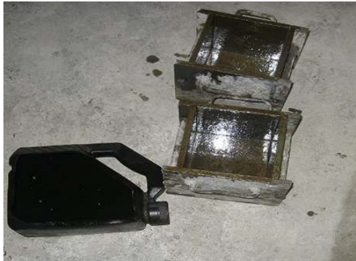
Figura 4.1.(a): Moldes Metálicos de 15x 15 cms. Provistos de Desmoldante (Fuente: Silva, 2007)
