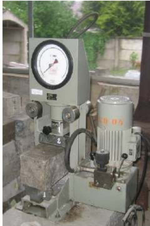
Figura 2.3.5: Prensa Hidráulica Para Ensayos de Probetas a Tracción por Flexión (Fuente: Elaboración Propia, 2009)
