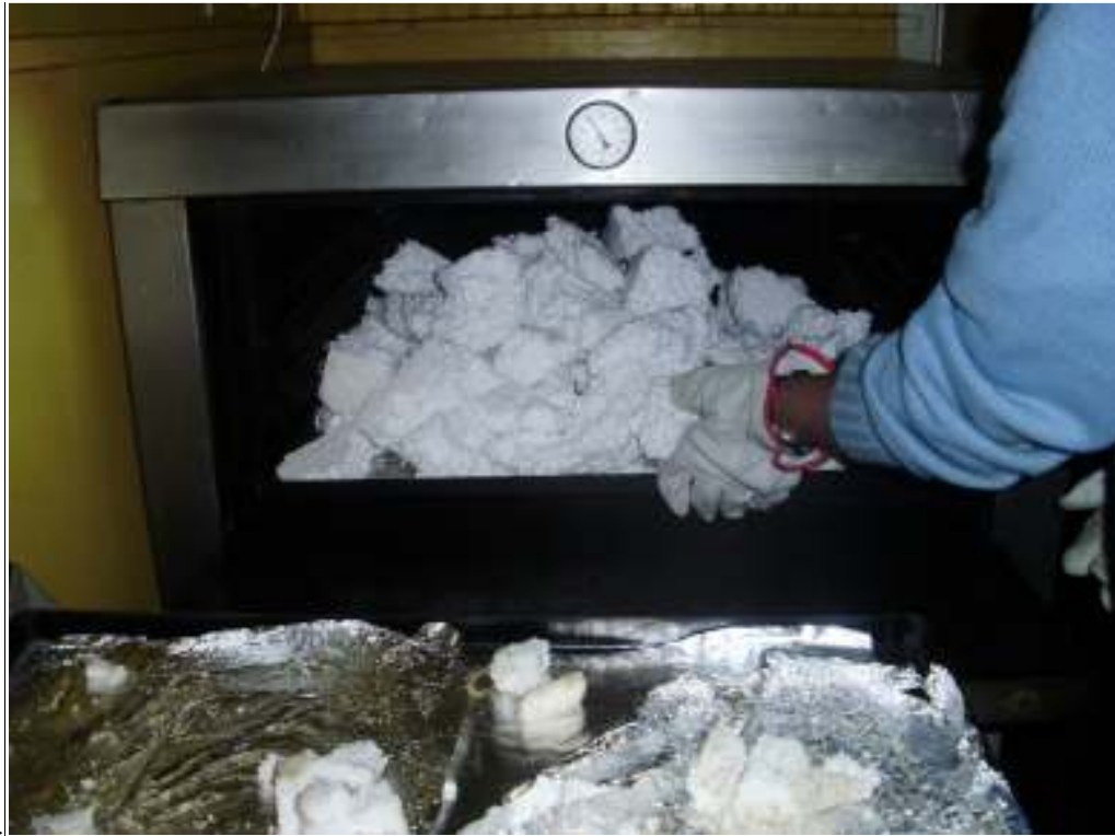
Figura III.2.5.2: Poliestireno Triturado en Horno Para su Modificación. (Fuente: Elaboración Propia)
