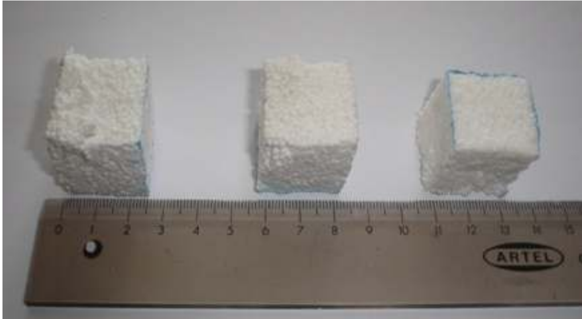
FiguraIII.2.5.4: Muestras de Poliestireno Modificado por Temperatura. (Fuente: Elaboración Propia)
