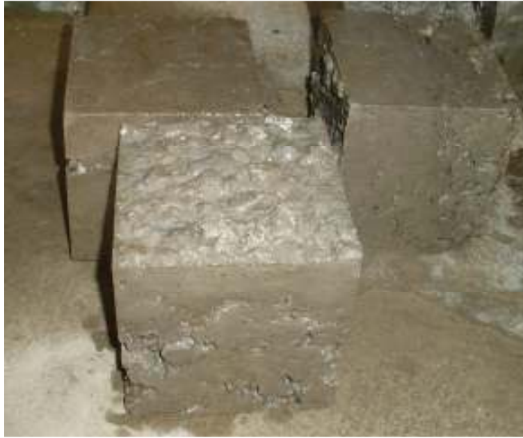
Figura 7.2: Probetas Rechazadas Por Presencia de Nidos. (Fuente: Elaboración Propia)
