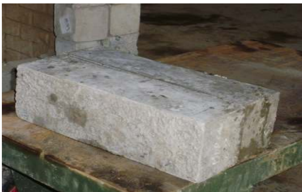
Figura 5.5.2: Probetas Prismáticas para Ensayo a Tracción por Flexión. (Fuente: Elaboración Propia)
