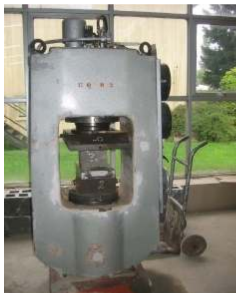
Figura 2.3.4: Prensa Hidráulica Para Ensayo de Compresión (Fuente: Elaboración Propia, 2009)
