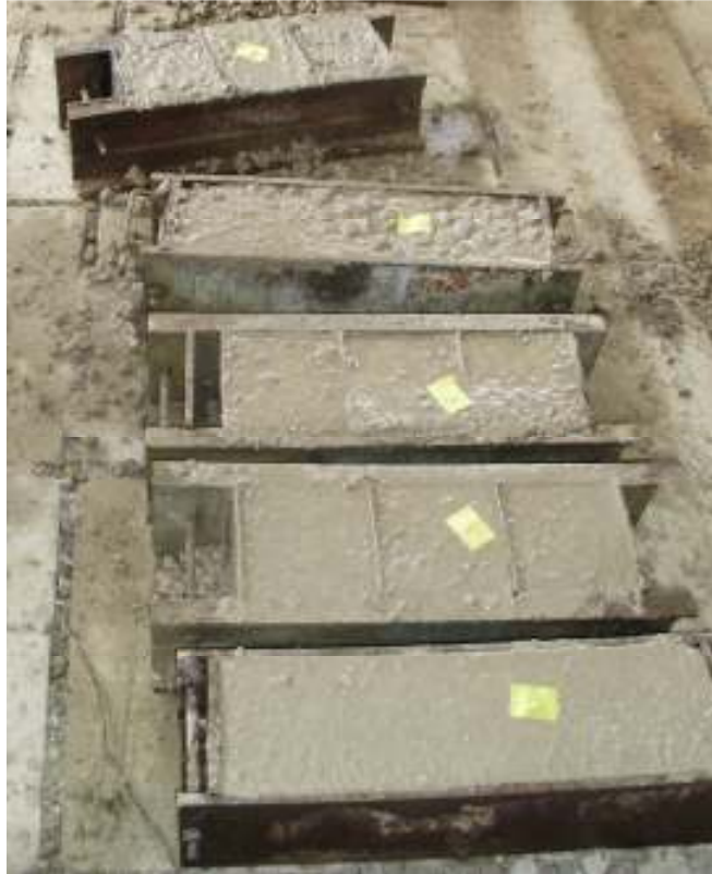
Figura 4.1.(c): Llenado y Rotulación de Moldajes Para Probetas de Ensayo. (Fuente: Elaboración Propia)
