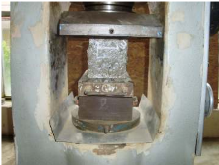
Figura 5.4.2: Ensayo a Compresión de Probetas de Hormigón. (Fuente: Elaboración Propia)
