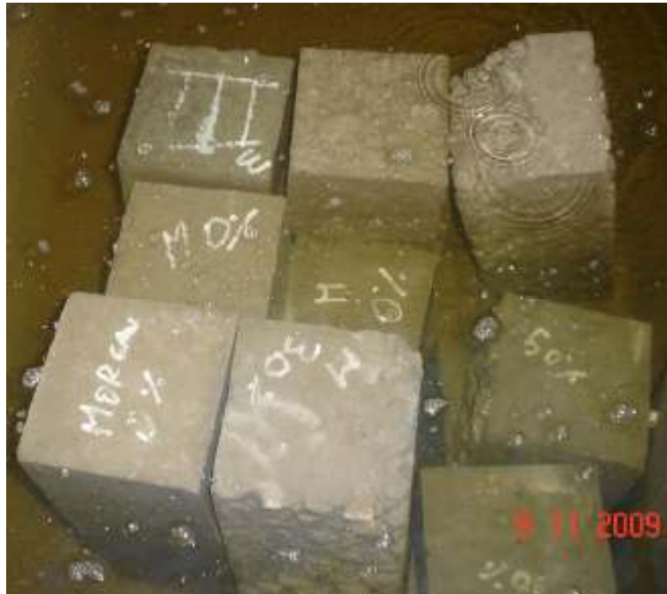
Figura 4.3: Curado de Probetas en Piscina del LEMCO. (Fuente: Elaboración Propia)
