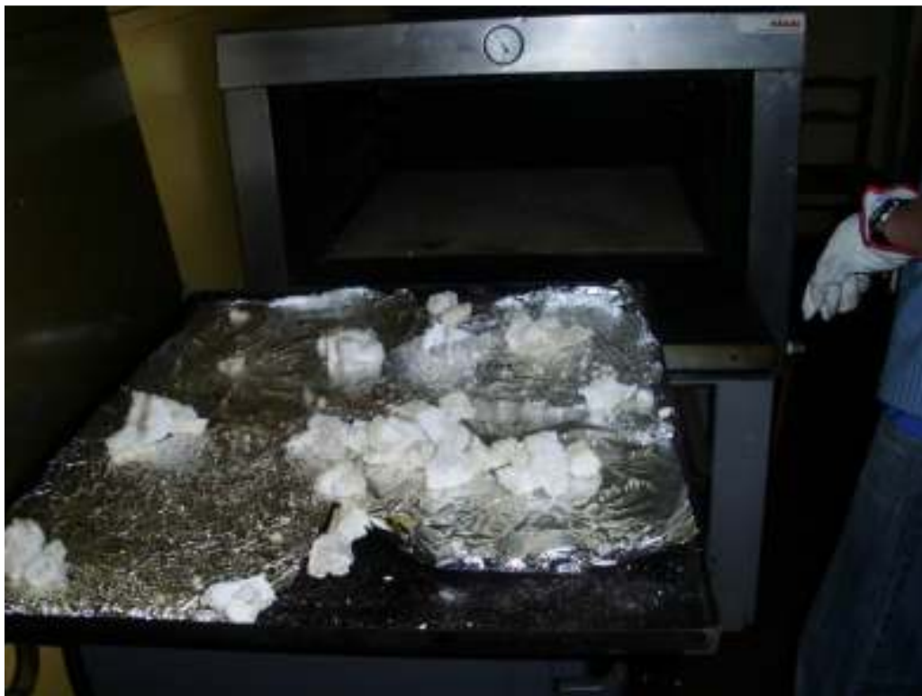
Figura III.2.5.3: Retiro del Poliestireno del Horno, Haciéndose Evidente su Disminución de Tamaño. (Fuente: Elaboración Propia)
