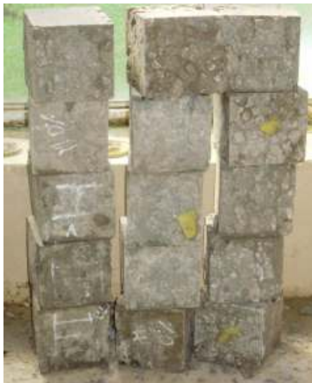
Figura 7.1: Probetas Cúbicas de Hormigón Para Ensayo a Compresión. (Fuente: Elaboración Propia)
