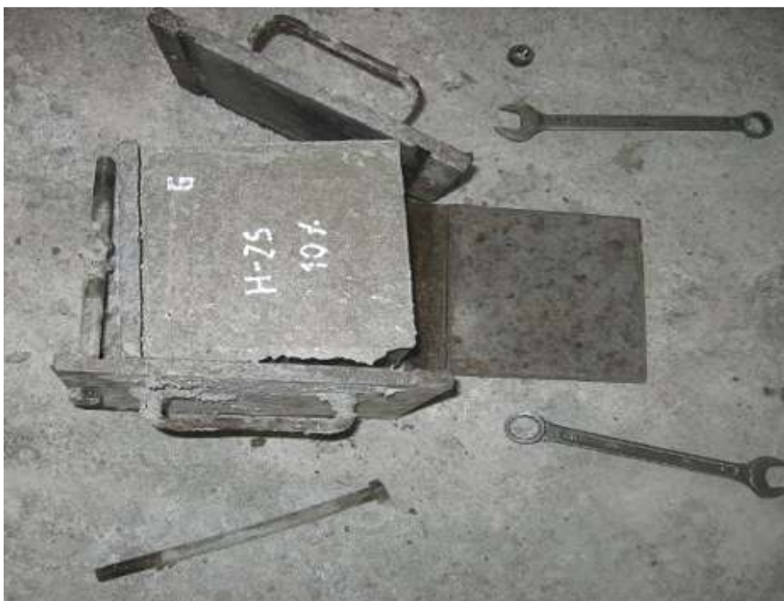
Figura 4.2.(a): Desmolde de Probetas de Hormigón. (Fuente: Silva, 2007)
