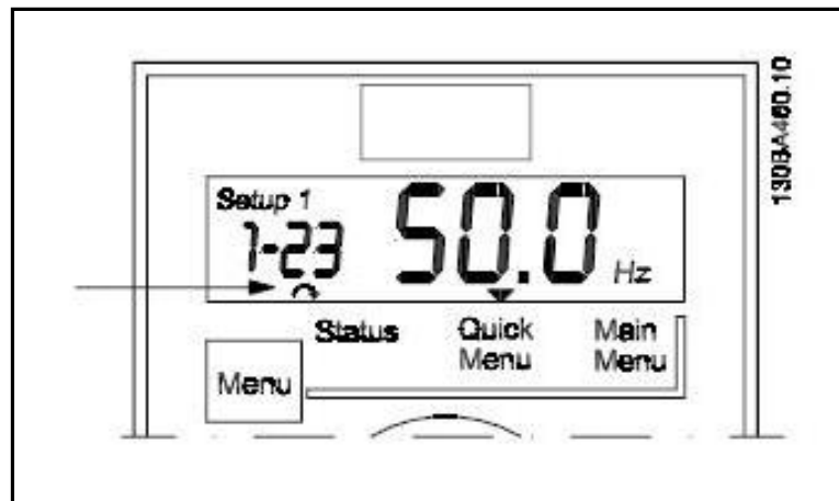
FIGURA N° 15: Indicación de la dirección de la bomba.
