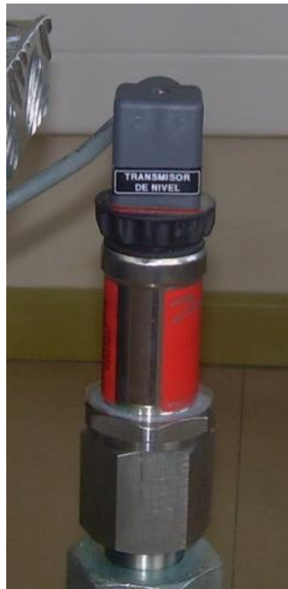
FIGURA N° 32: Transmisor de nivel
