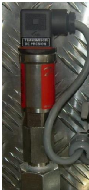
FIGURA N° 31: Transmisor de presión
