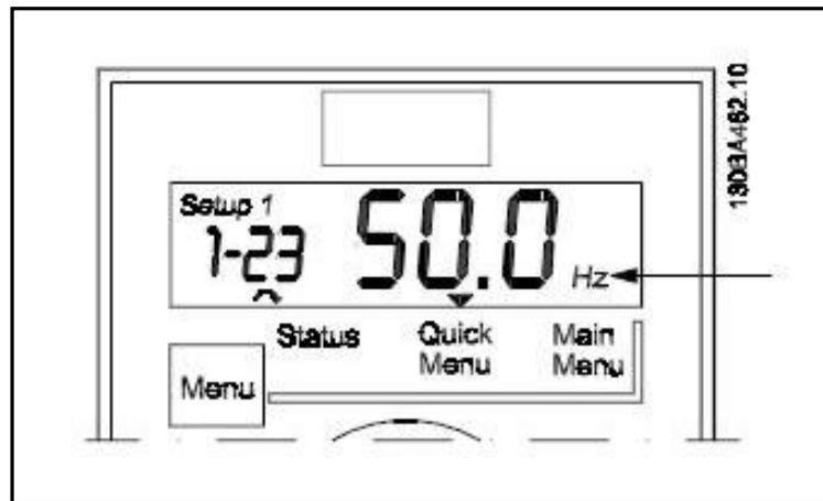
FIGURA N° 14: Indicación de la unidad del parámetro seleccionado.
