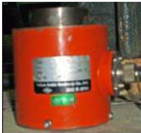
Figura 3.9 Celda de Carga
