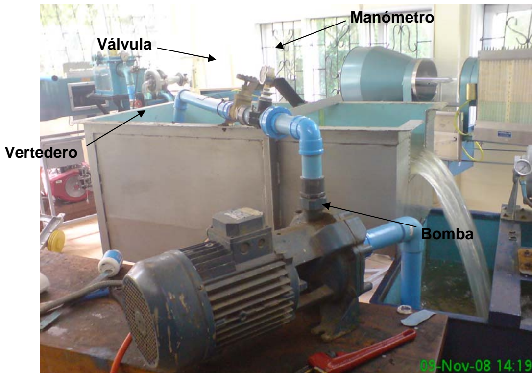
Figura N° 4 Ensayo a bomba para obtención curva Caudal v/s Presión.
