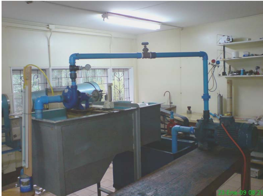
Figura N° 9 Laboratorio de ensayo bomba-turbina.
