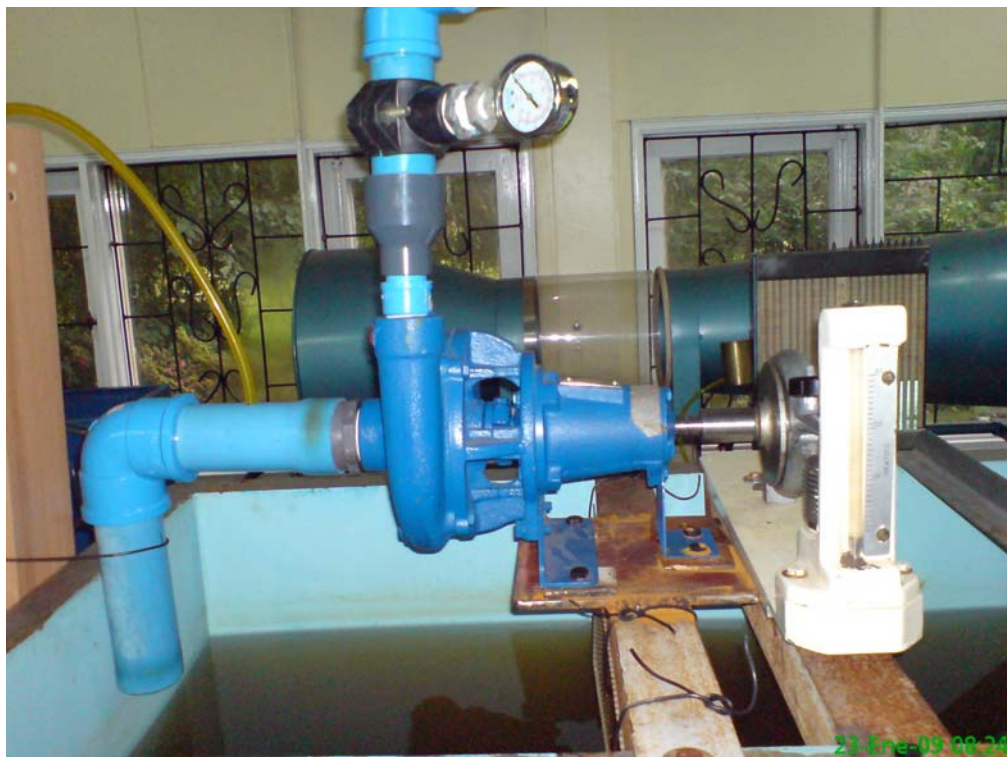
Figura N° 10 Bomba a ensayar como turbina montada para experimento.
