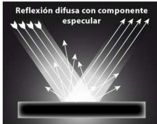
Figura 4.10: Reflexión difusa con componente especular (regular).
