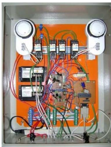
*Figura 5.18: Caja metálica con los circuitos de carga, control y descarga de los paneles y baterías.*
