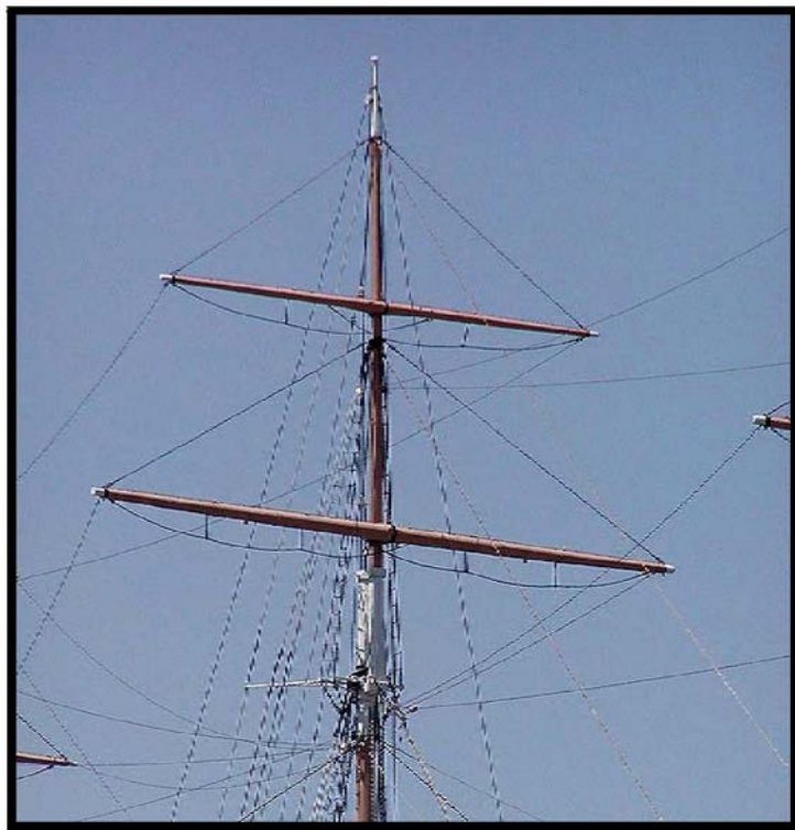
Figura 39, (Vergas típicas de un mástil).
