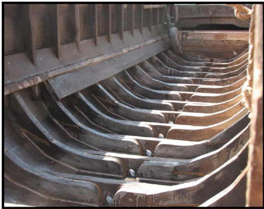
Figura 3, (Cuadernas Labradas con reviro)
