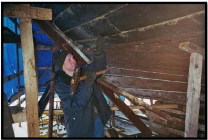
Figura 5, (Forro unido tope a tope) Se muestra el calafateo de la tablazón.
