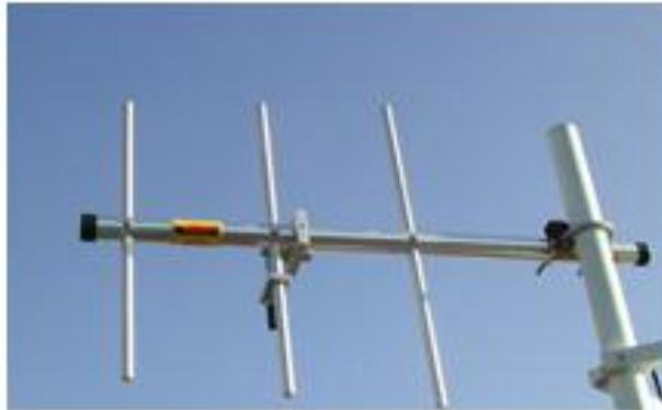
Figura 5.3: Yagi de 3 elementos
