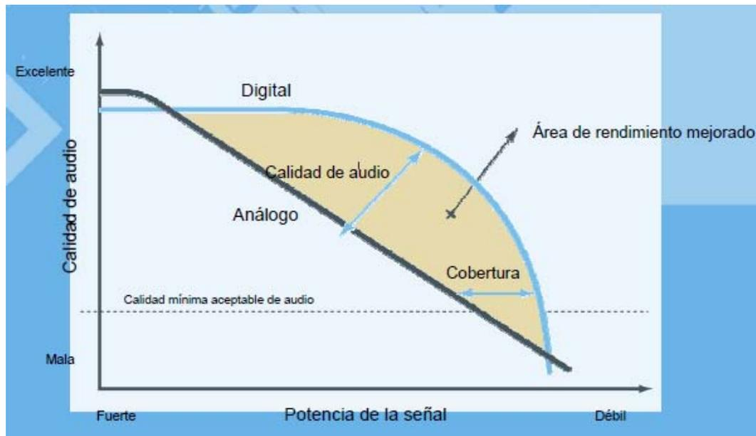
Figura 7.6: Grafico potencia de la señal v/s calidad de audio referente a MOTOTRBO
