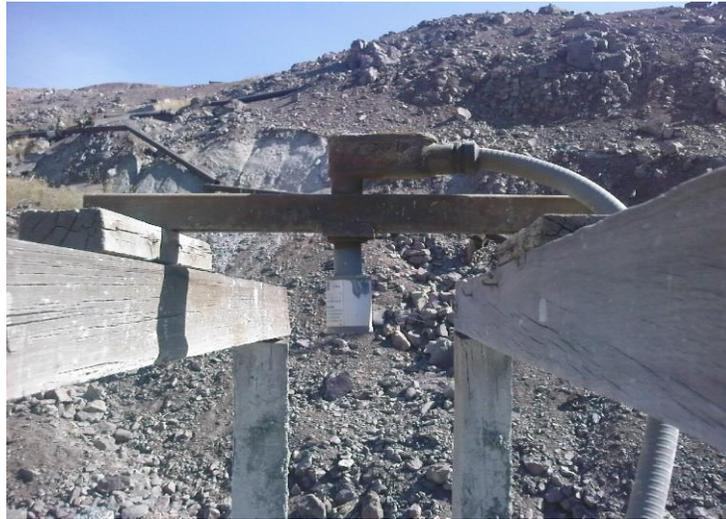
Figura 5.13: Instalación del sensor de prueba
