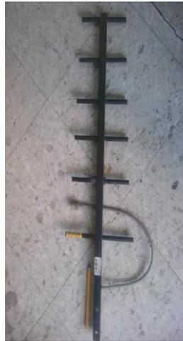
Figura 6.10: Yagi 6 elementos
