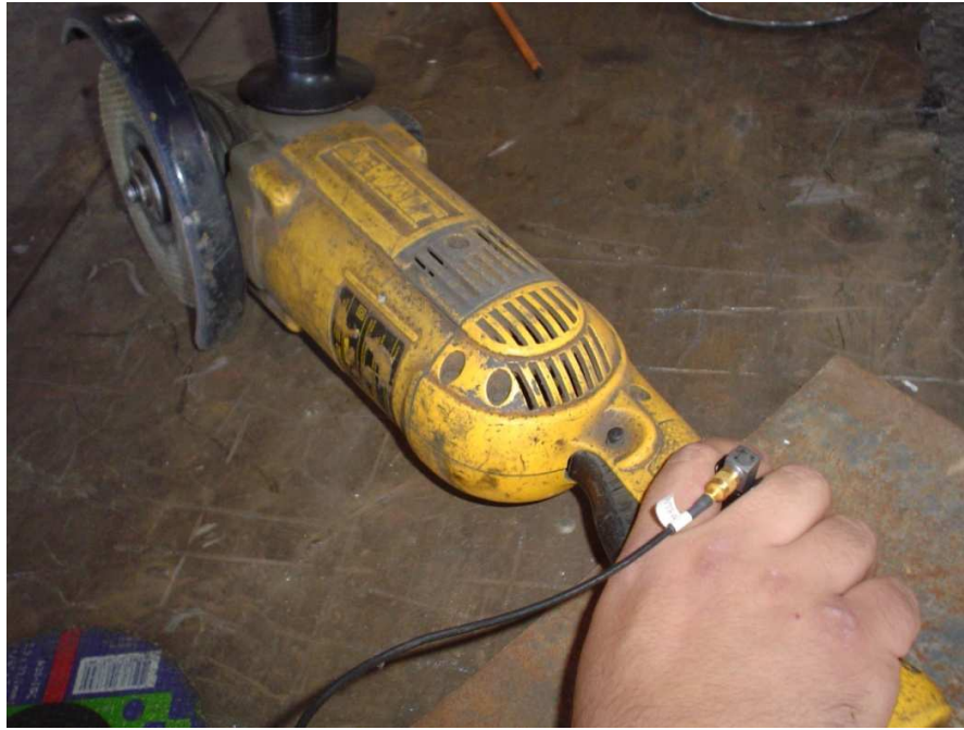
Figura 19. Montaje utilizado para medir una exposición de mano-braza al utilizar un esmeril angular.
