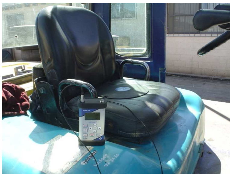
Figura 17. Montaje utilizado para medir exposición de cuerpo entero en grúa horquilla.
