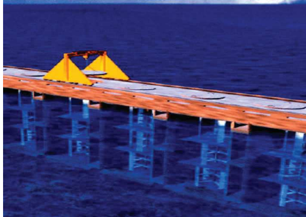
Figura 1.12.a Sistema de generación con turbinas verticales para corrientes marinas, diseñado en Canadá. 11
