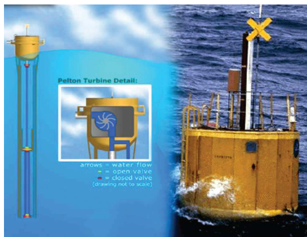
Figura 1.b Prototipo boya generadora de energía por el movimiento del oleaje, llamado AquaBuOY 8
