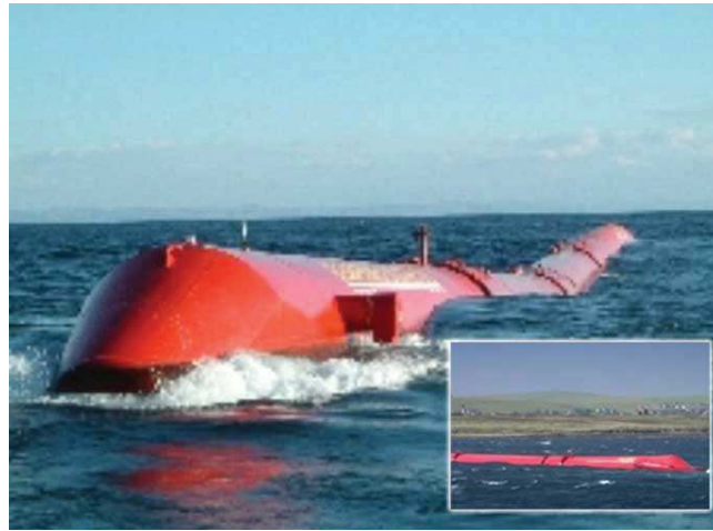
Figura 1.c Sistema Pelamis desarrollado en Inglaterra. Genera en promedio 20 MW 9
