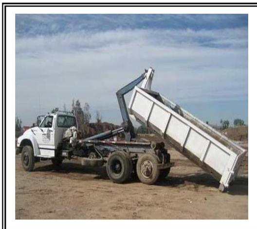
**Figura 3.2:** Contenedor de escombros y camión con levante hidráulico.
